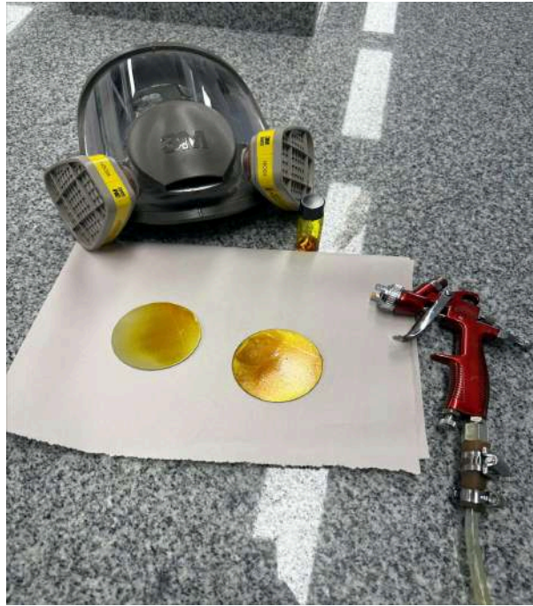
Figura 11. Equipamiento utilizado para el método de “Spray Coating”.
