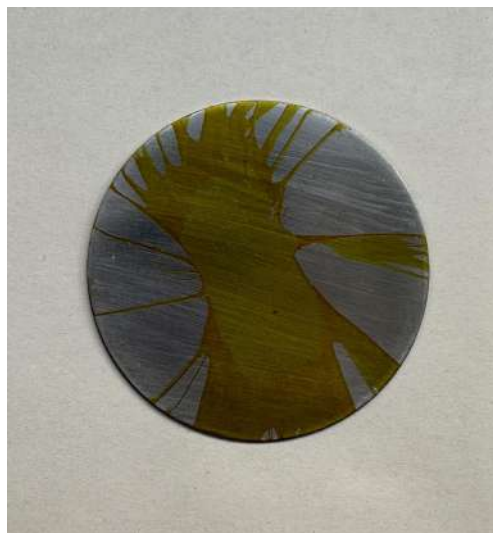
Figura 14. Recubrimiento obtenido por método de “Spin Coating”.
