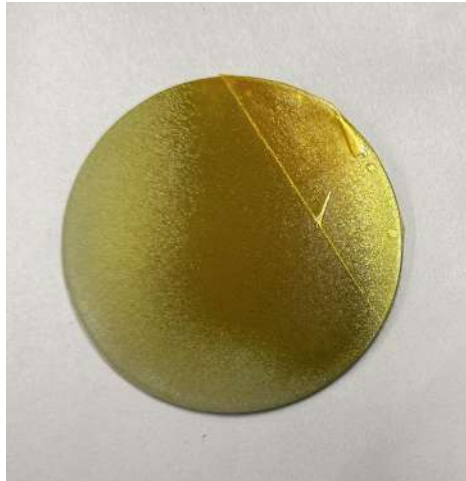
Figura 15. Recubrimiento obtenido por método de “Spray Coating”.
