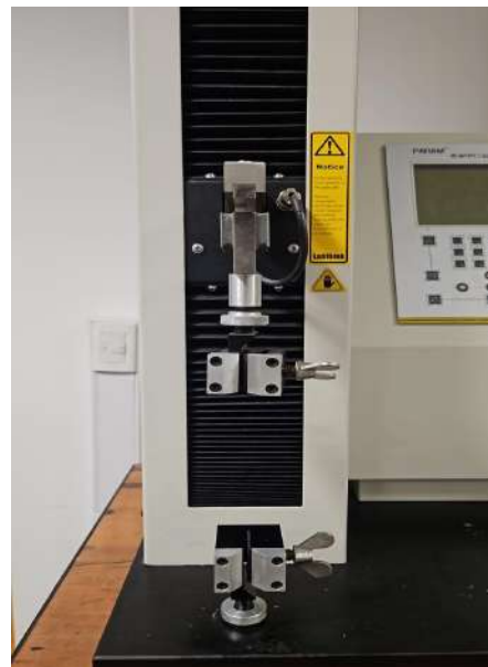
Figura 18. Máquina de tracción utilizada en el ensayo de adhesión.
