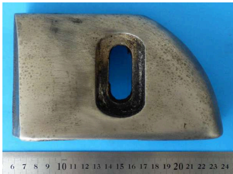
Figura 3.53. Desgaste en pastilla PGFB.
