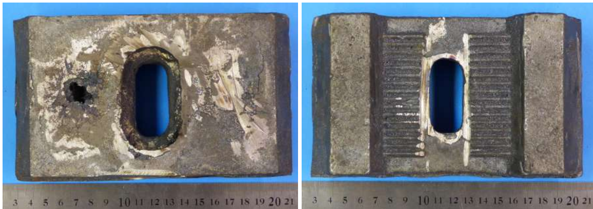
Figura 3.14. Piezas PABLC realizadas en el INTEMA, con rechupe superficial a la izquierda de la cara frontal, en la zona del realimentador.
