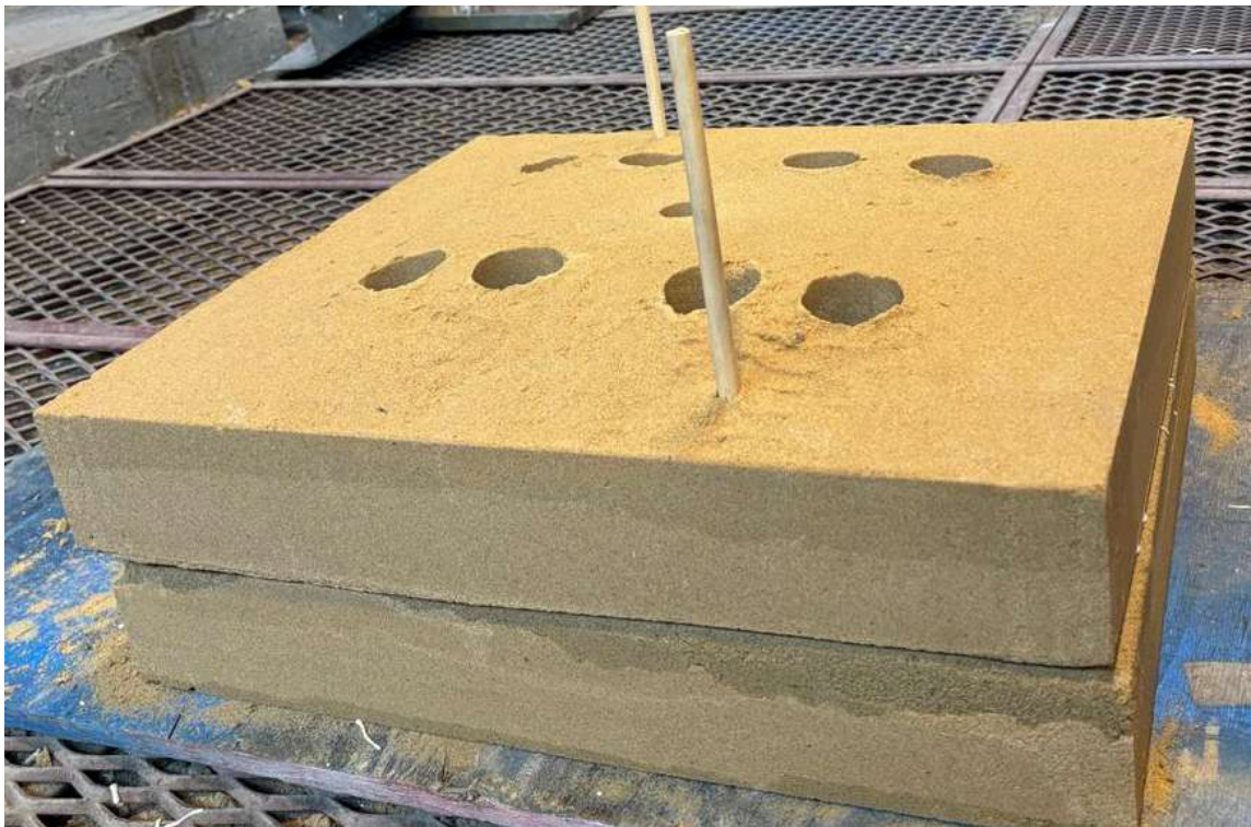
Figura 3.12. Molde cerrado. Sobre y bajero pegado con bentonita.
