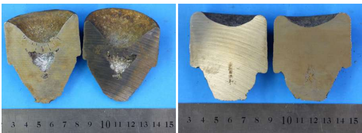
Figura 3.15. Vista interior de mazarotas, evaluación de eficiencia mediante rechupe interno.
