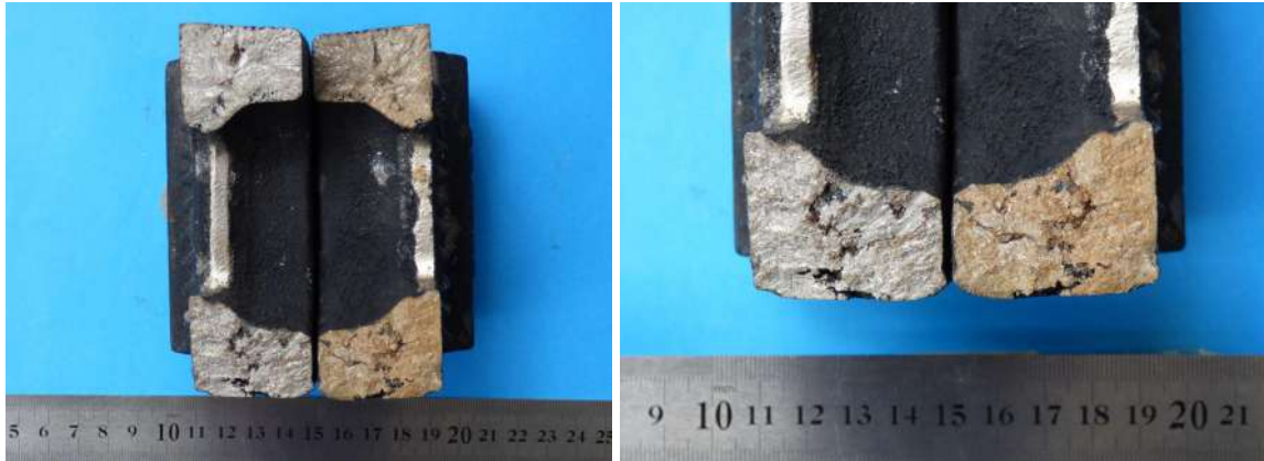
Figura 3.23. Superficie de fractura en pastilla PLFB.
