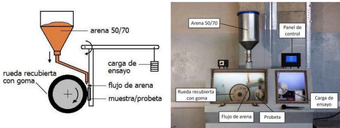
Figura 2.1. Ensayo de desgaste por abrasión según norma ASTM G65, a) esquema de la máquina, b) equipo utilizado, señalando los elementos principales.
