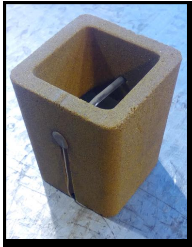
Figura 2.01: Copa de análisis térmico.
