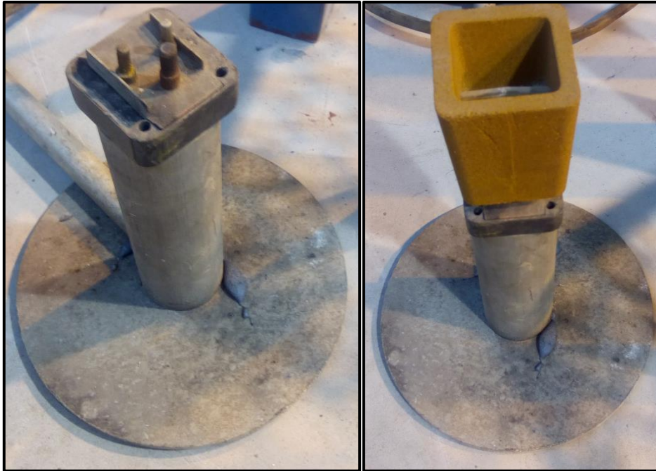
Figura 2.02: Porta Copa de análisis térmico con y sin la copa.
