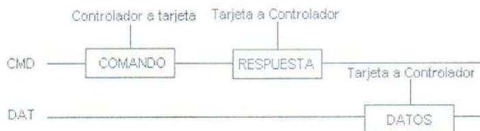
Figura 2.5. Operación de lectura de la tarjeta en modo MMC
