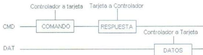
Figura 2.6. Operación de escritura en la tarjeta en modo MMC
