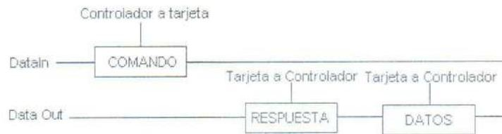
**Figura 2.7.** Operación de lectura de la tarjeta en modo SPI
