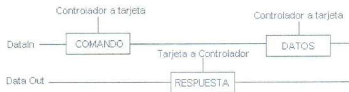
**Figura 2.8.** Operación de escritura en la tarjeta en modo SPI
