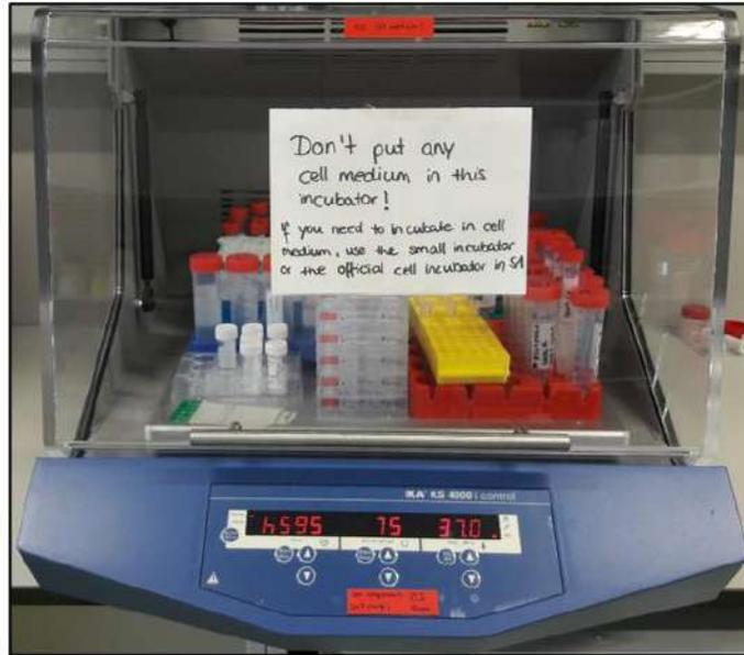
Figura 4-6: Muestras colocadas dentro de la incubadora a 37°C y 75 rpm.
