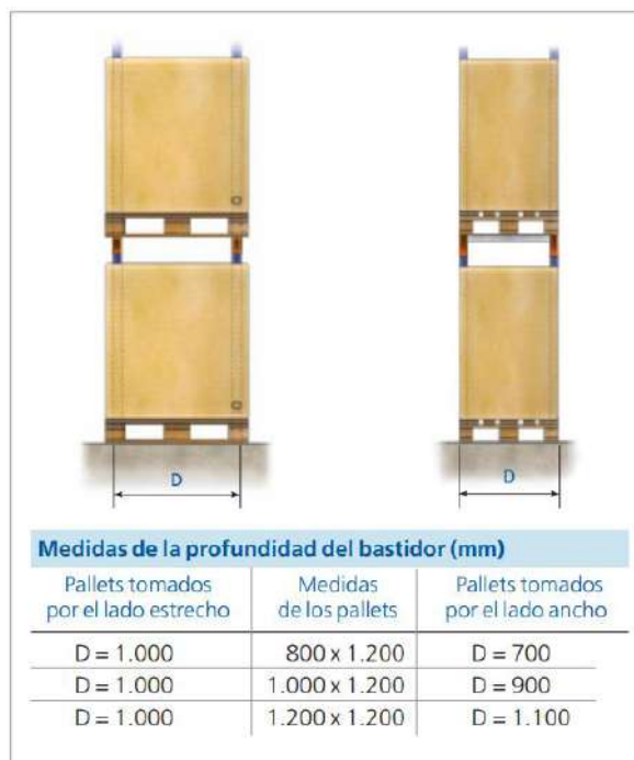
Figura II.5: Medidas de la profundidad del bastidor. Fuente: Mecalux®.
