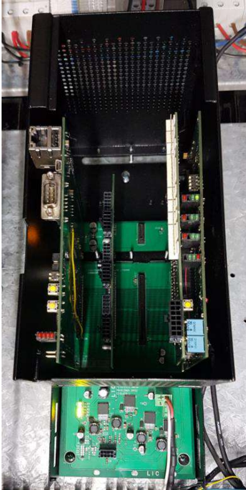
Conjunto de PCBs que componen la plataforma de control implementada en el LIC.
