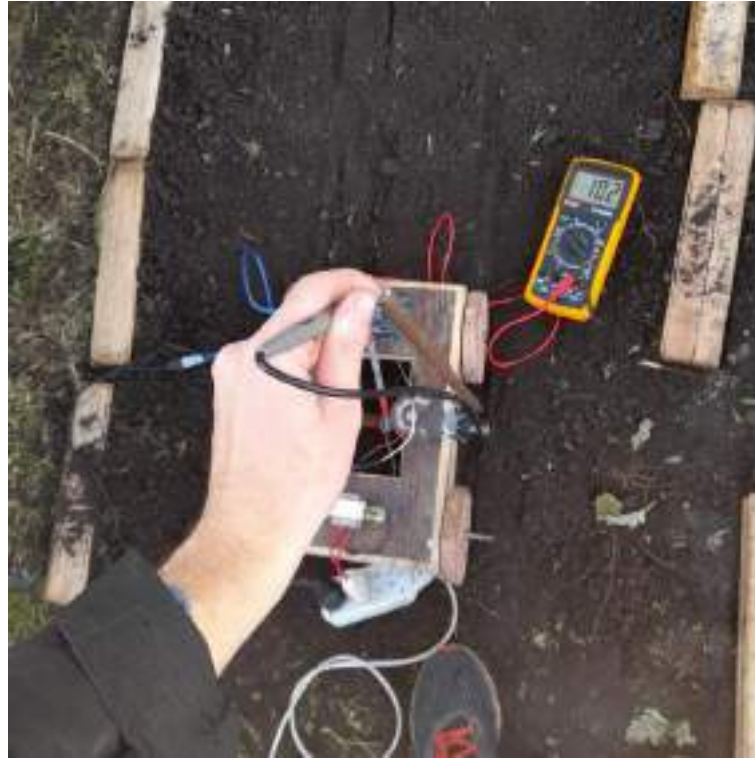
Figura 3.75 – Medición de caídas de tensión. Fuente: elaboración propia.
