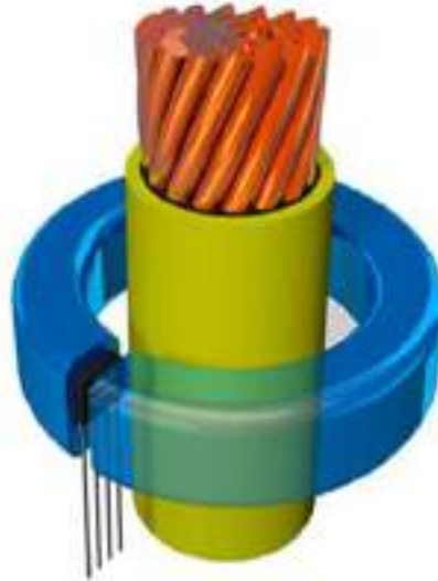
Figura 3.49 – Disposición del sensor de efecto Hall típico. Fuente: [24].
