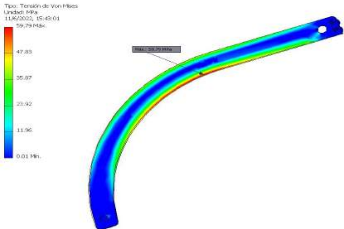
Figura 3.26 – Resultado de simulaciones del brazo del disco de sensado. Fuente: elaboración propia.
