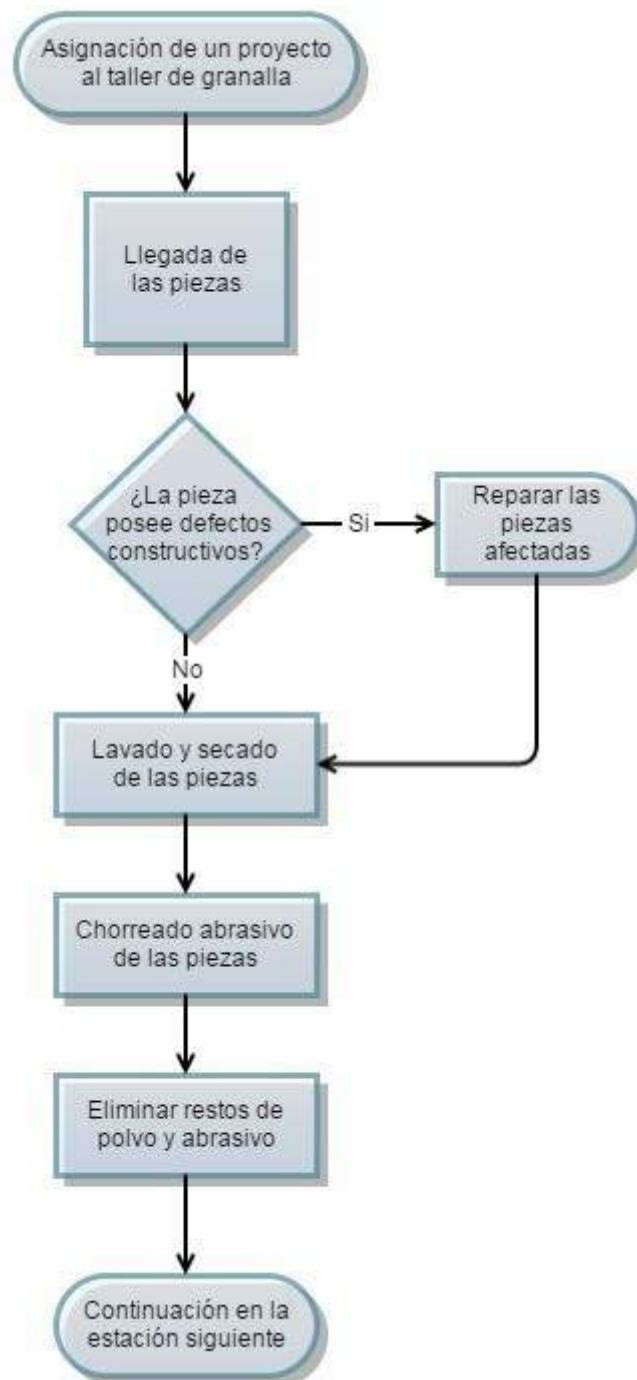
Figura I.7 Diagrama de flujo del proceso de Granalla
