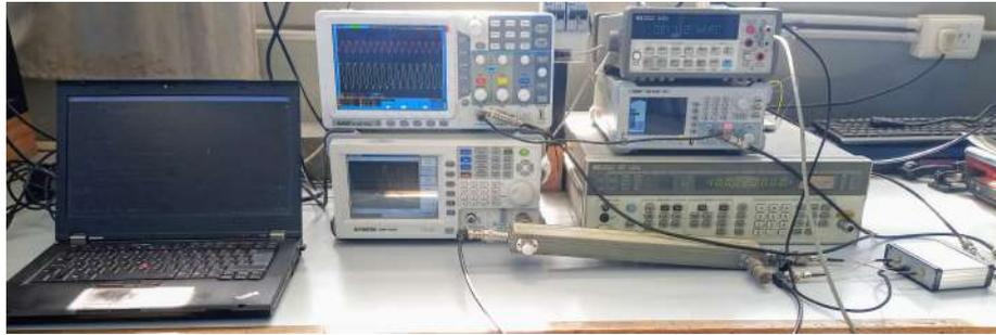
Figura 4.3: Banco de medición para la ganancia del up-converter en serie con el down-converter (implementación)
