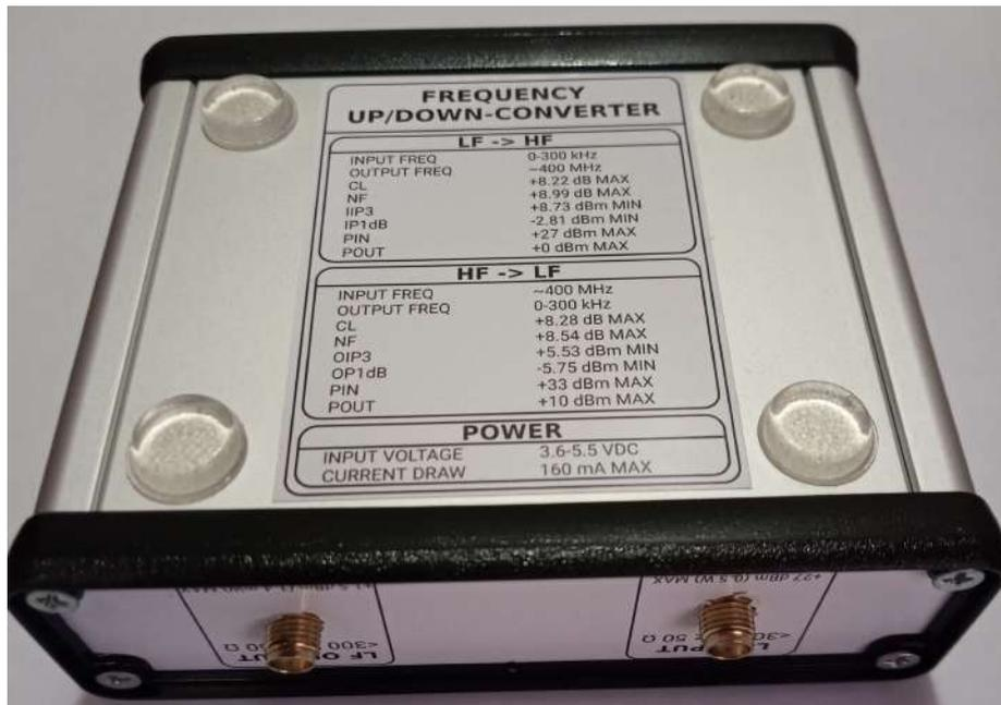
Figura 3.26: Dispositivo terminado (cara inferior)
