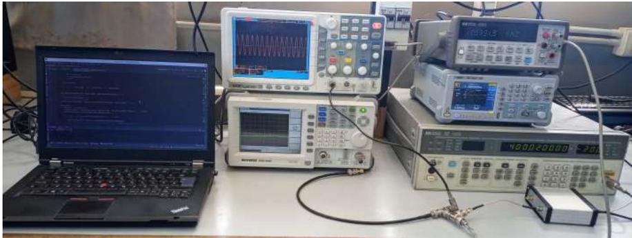
Figura 4.9: Banco de medición para magnitud de la ganancia down-converter (implementación)
