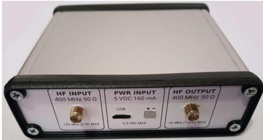
Figura 3.25: Dispositivo terminado (cara de alta frecuencia)
