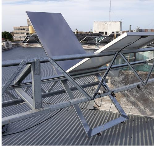
Figura D.1: Reflector a 45°
