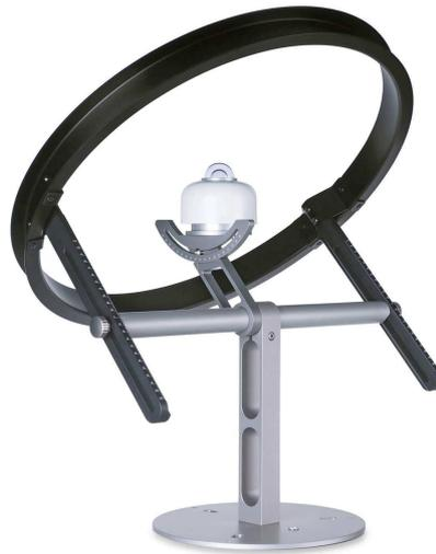
Figura 1.11: Piranómetro con anillo de sombreo para medición de radiación difusa
