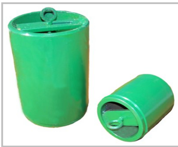
Figura 1.2 - Drift utilizado para la calibración de los tubos.
