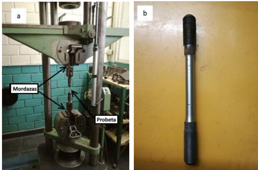
Figura 5.6 a) Máquina de tracción MOHR & FEDERHAFF y b) Vista de una probeta de tracción.
