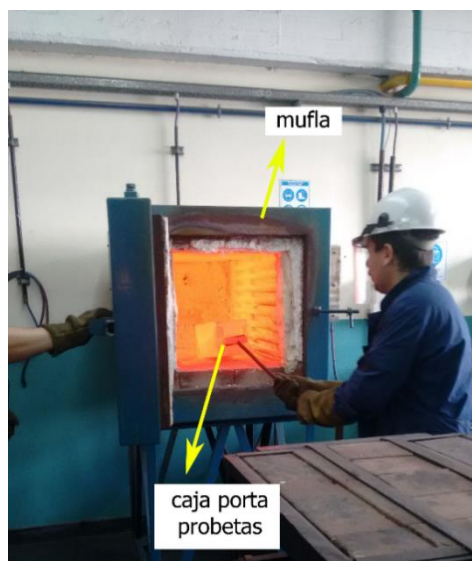
Figura 5.4 Horno eléctrico utilizado para los tratamientos térmicos.
