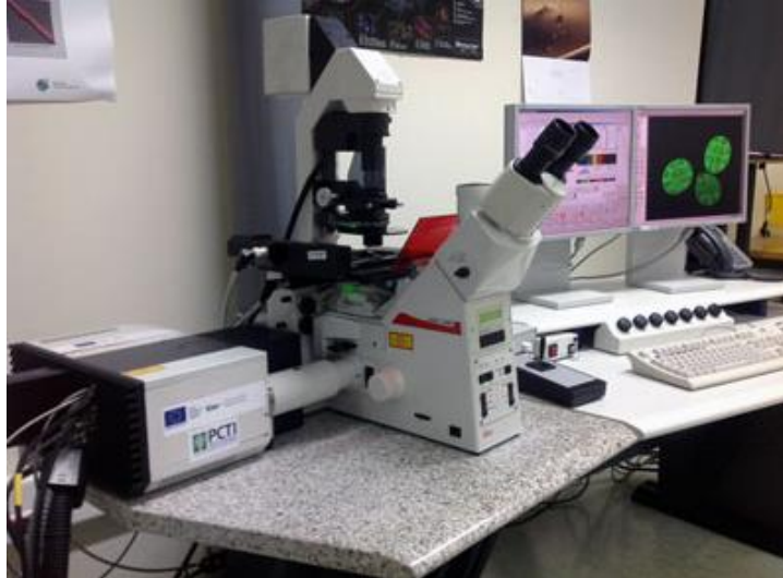
Figura 22. Microscopio láser confocal Leica SP2.
