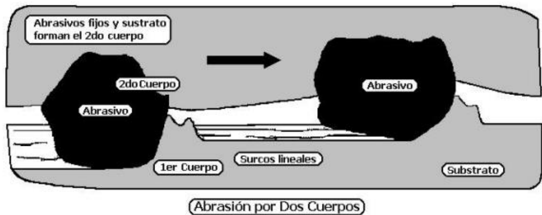
Figura 11. Abrasión por dos cuerpos.
