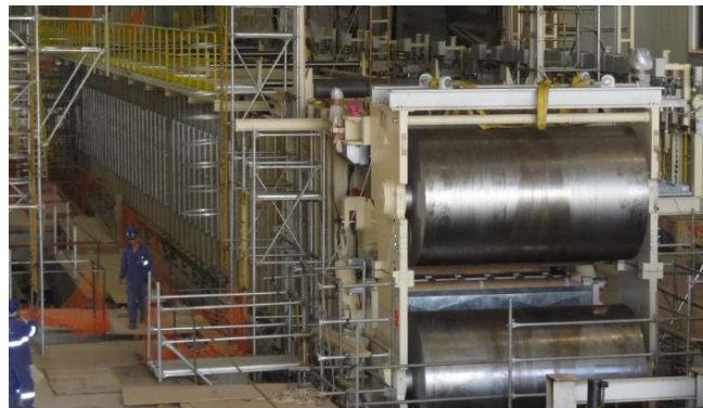
Figura 3. Prensa continua para la fabricación de MDF.
