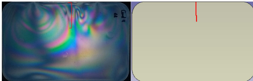
Figura 5.5: Placa inyectada experimental (izq.) vs. Placa simulada en Moldex3D (der.) con sus líneas de soldadura. Condición 4.
