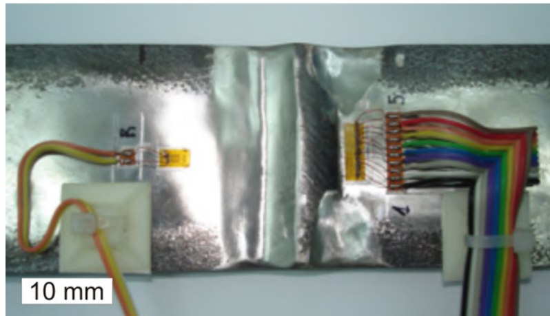
Figura C.8: Vista general de una probeta lista para ser ensayada. Los strain gauges ubicados a la derecha son los encargados de la detección y monitoreo de las fisuras, el sensor colocado a la izquierda se destina a la medición del campo de tensiones nominal aplicado a la muestra.
