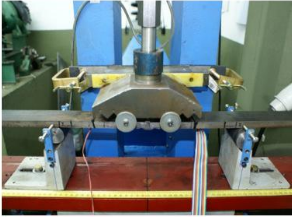
Figura 4.5: Disposición de una muestra de 1/4" instrumentada y lista para ensayar, a la derecha se observa un esquema del arreglo del tren de carga
