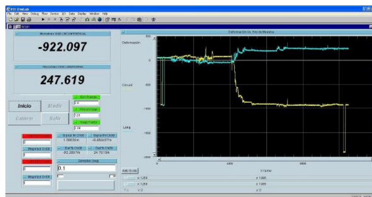
Figura G.5: Programa de medición realizado para la prueba. Las mediciones fueron realizadas en \mu\epsilon y luego convertidas a tensión en MPa.
