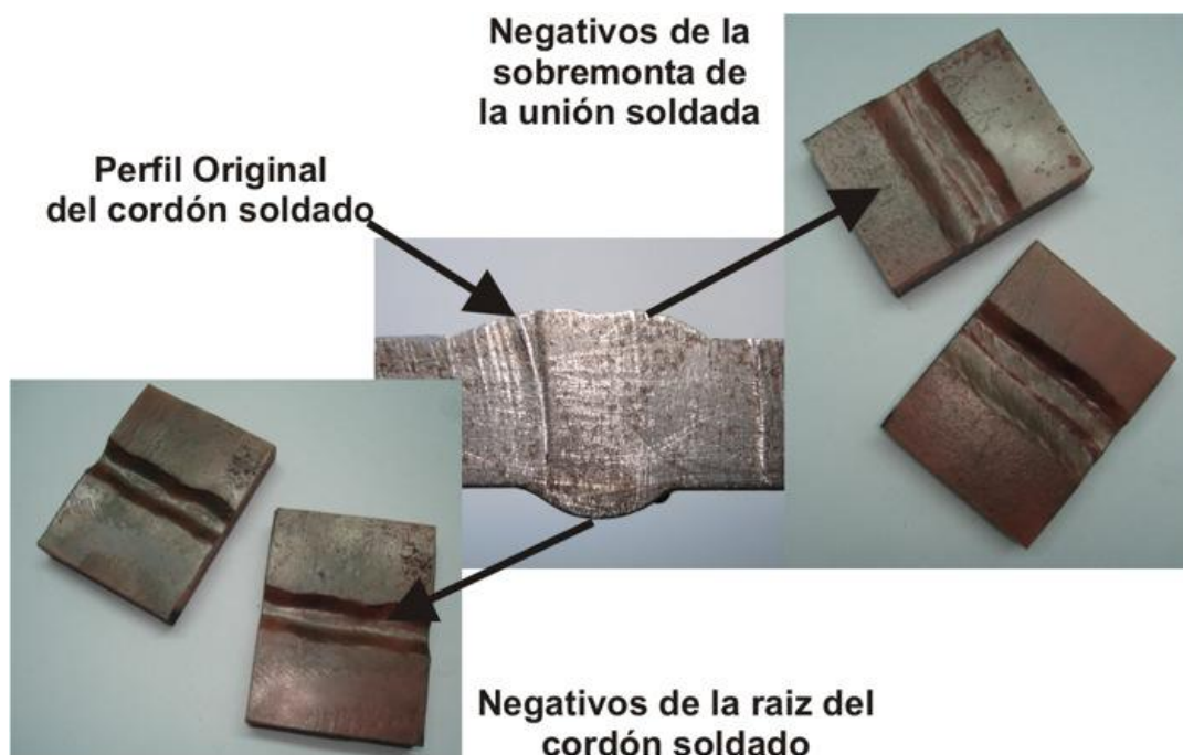
Figura H.2: Negativos de material plástico obtenidos por colado de un polímero autocurable sobre la unión soldada que se desea relevar.
