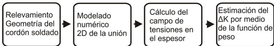
Figura 4.11: Etapas de trabajo desarrolladas para el cálculo del \Delta K . El relevamiento de la geometría permitió que los modelos teóricos presenten una mayor aproximación.
