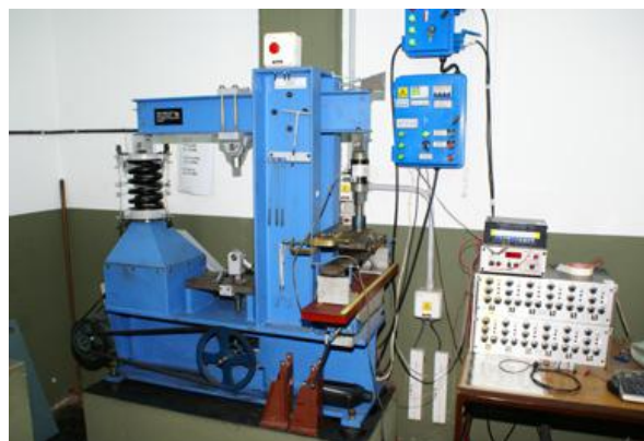
Figura D.2: Máquina de ensayos de fatiga "Walking Beam" utilizada en los ensayos.
