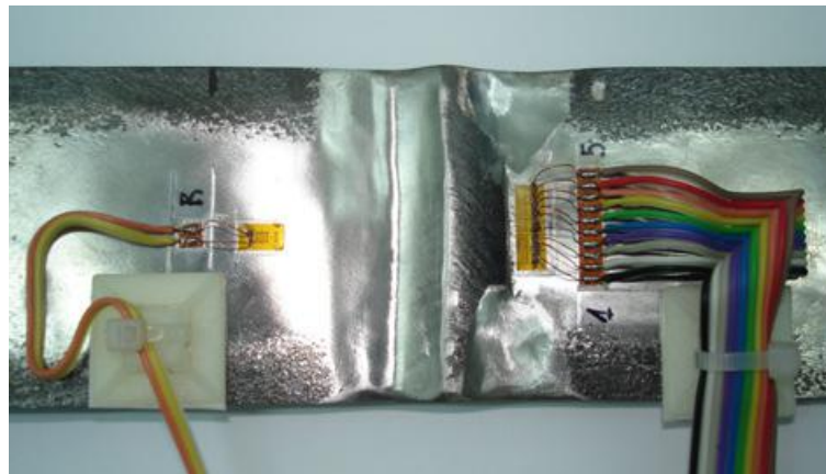
Figura 4.7: Instrumentación completa de una muestra de 1/4", se observa la disposición de los strain gauges de detección y monitoreo de fisuras y el canal remoto para la medición del rango de tensiones aplicado a la muestra.
