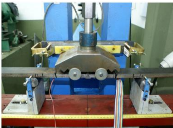
Figura D.3: Disposición de una muestra de \frac{1}{4} " instrumentada y lista para ensayar, a la derecha se observa un esquema del arreglo del tren de carga.
