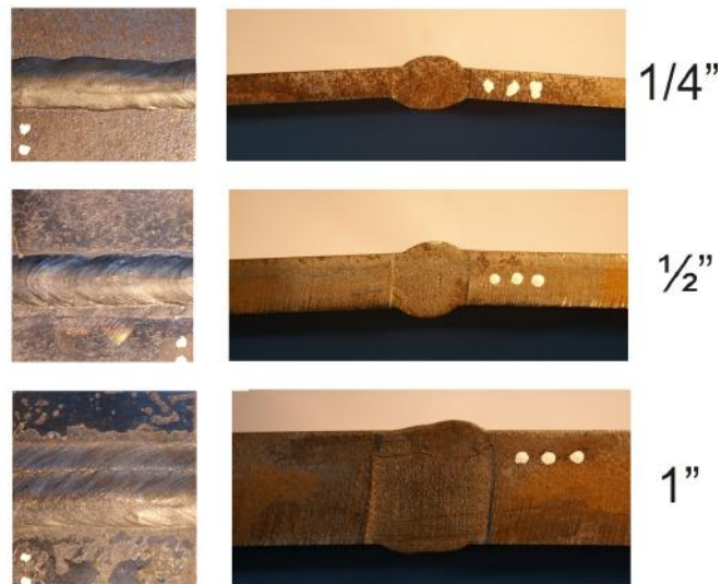
Figura 4.3: Perfiles resultantes del proceso de soldadura en los tres espesores de placa base.
