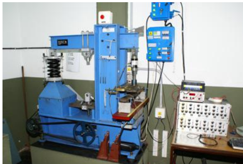
Figura 4.4: Maquina de ensayos de fatiga "Walking Beam" utilizada en los ensayos.
