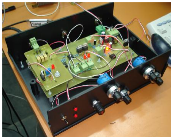
Figura D.10: Se construyó un modulo de prueba para verificar la estabilidad y funcionamiento del diseño implementado.
