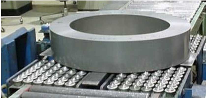
Figura 1.24 Toroide construido a partir de cinta de metal amorfo.
