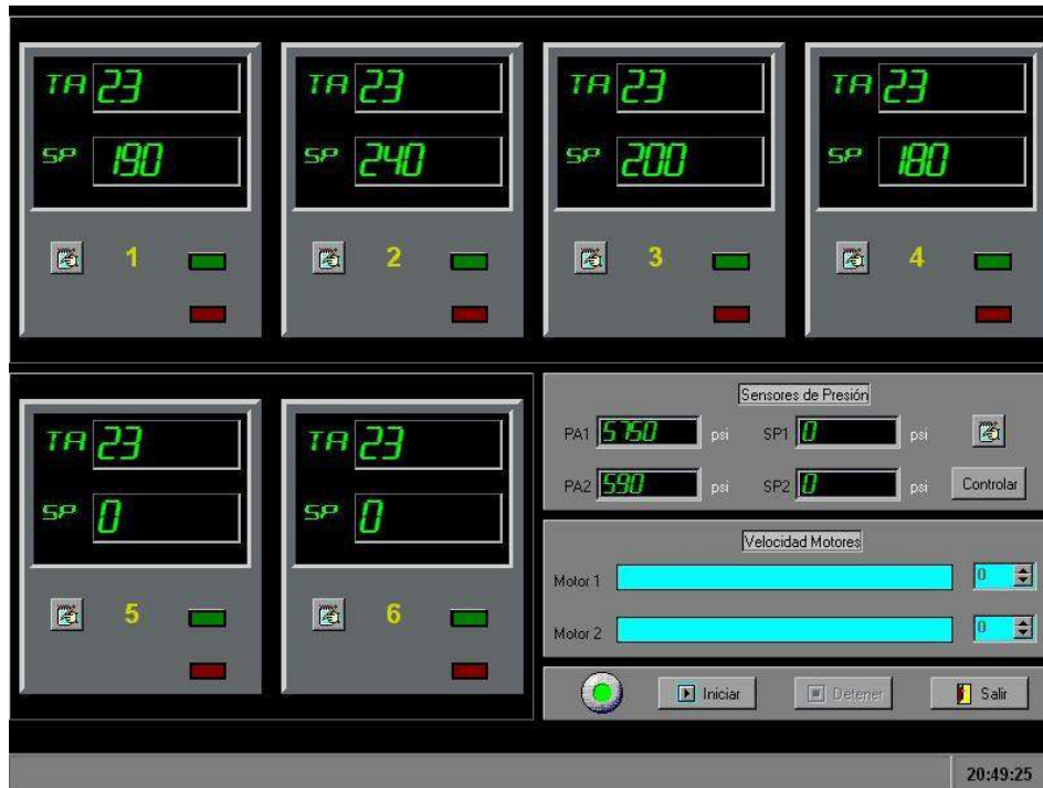
Imagen 6.4 Captura de pantalla del programa de control de la extrusora
