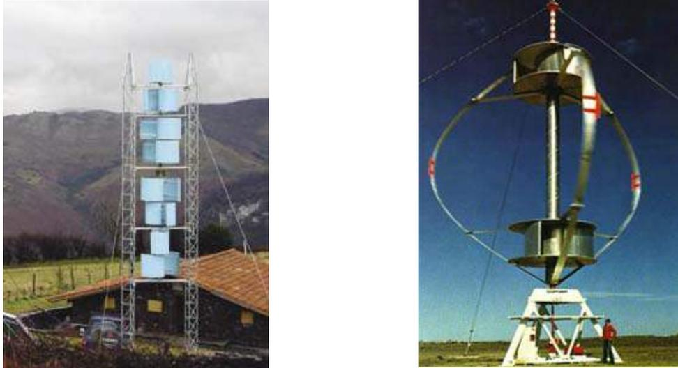
**Figura 3.2. Máquina de rotor tipo Savonius (izquierda) y de tipo Darrieus (derecha). Fuente: “Energía Eólica”; Universidad de Cantabria; Fernández Díez Pedro, 2003.**
