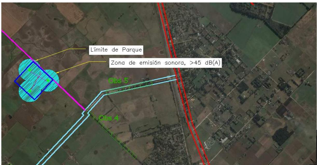
Figura 8.26. Alcance de las mediciones sonoras mayores según el arreglo y ubicación de los AE. Fuente: Elaboración propia
