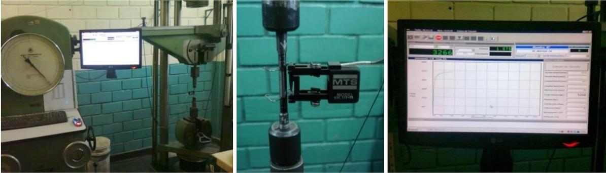
**Figura 5.9.** Ensayo de tracción. a) Equipamiento completo para realizar el ensayo; b) Montaje del extensómetro MTS; c) Visualización del sistema adquirente de datos.
