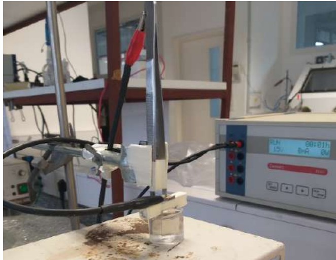
Figura 12. Configuración de la celda implementada para la deposición electroforética.
