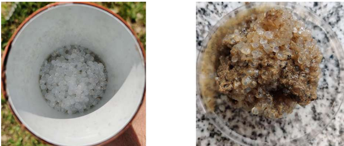
Figura 3.5. Hidrogel Control antes y después del ensayo.
