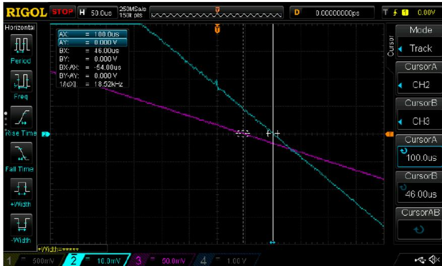
Figura 4.14: En violeta la onda del prototipo y en celeste la onda de la sonda Kyoritsu. El  $\Delta t$  ( $BX - AX$ ) es de 54 [ $\mu s$ ] en adelante
