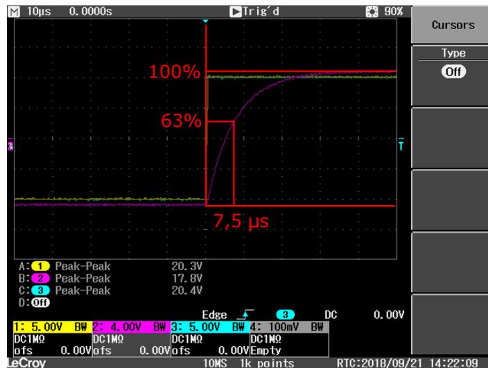
(b)  $v_g = 20V_{pp}$ Figura 2.5: Respuesta al escalón obtenida para distintas  $v_g$
