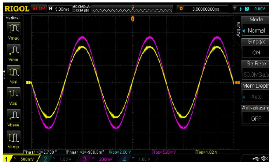
Figura 4.13: Forma de onda de la tensión de la sonda prototipo (Amarilla) y Transductora Kyoritsu 3118 (Violeta) sin ningún tipo de filtrado. Corriente del banco: 750 [Arms]
