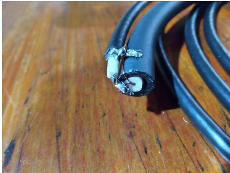
Figura 4.6: Vinculación de los extremos de la bobina con el cable transmisor
