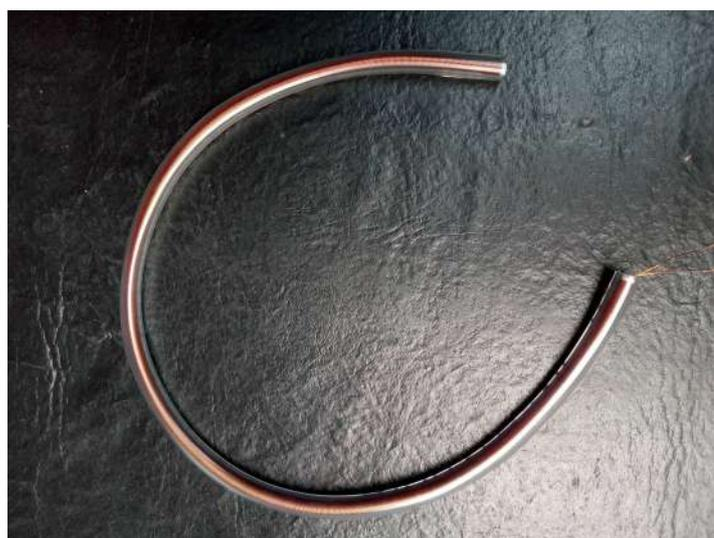
Figura 4.4: El devanado aislado con un material flexible de PVC
