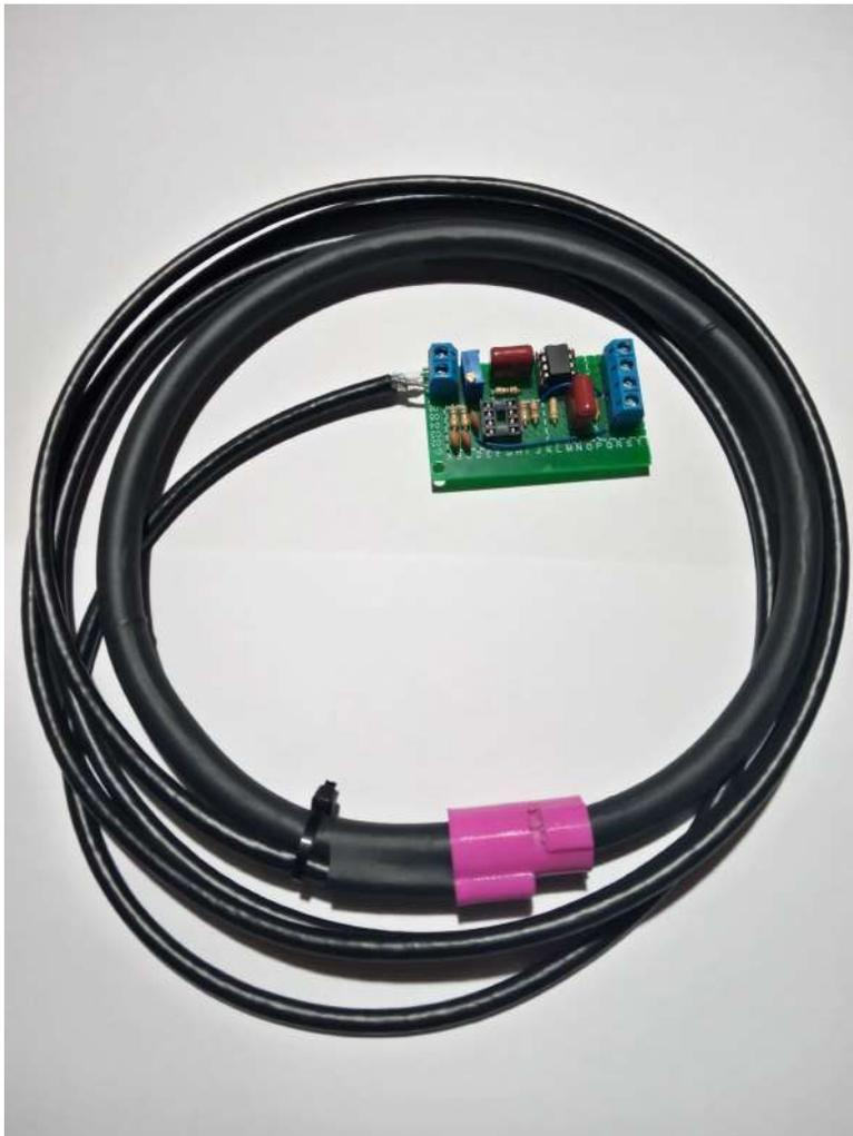
Figura 4.9: Prototipo completo de la sonda de corriente
