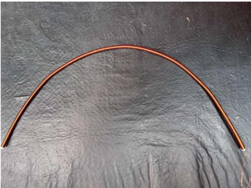
Figura 4.2: Alambre arrollado sobre el núcleo de manera uniforme
