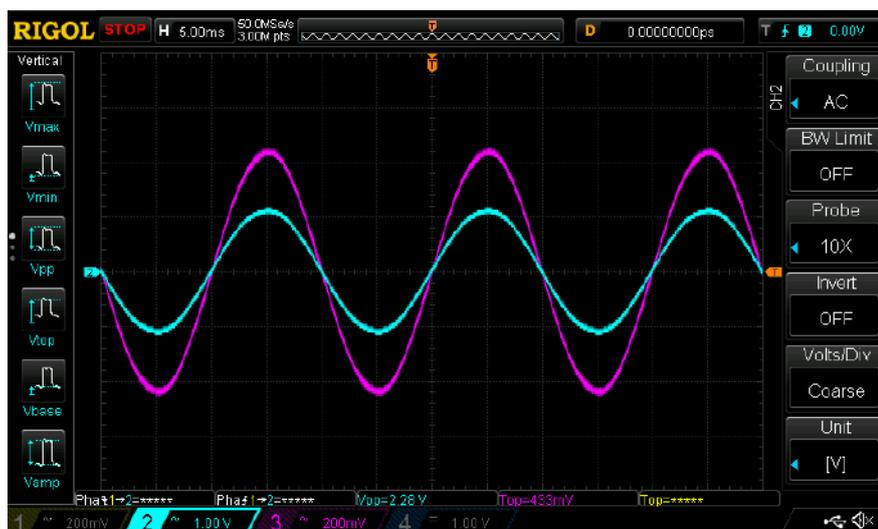
Figura 5.3: Forma de onda de la tensión de la sonda ECAMEC (Celeste) y Transductora Kyoritsu 3118 (Violeta) sin ningún tipo de filtrado. Corriente del banco: 300 [Arms]
