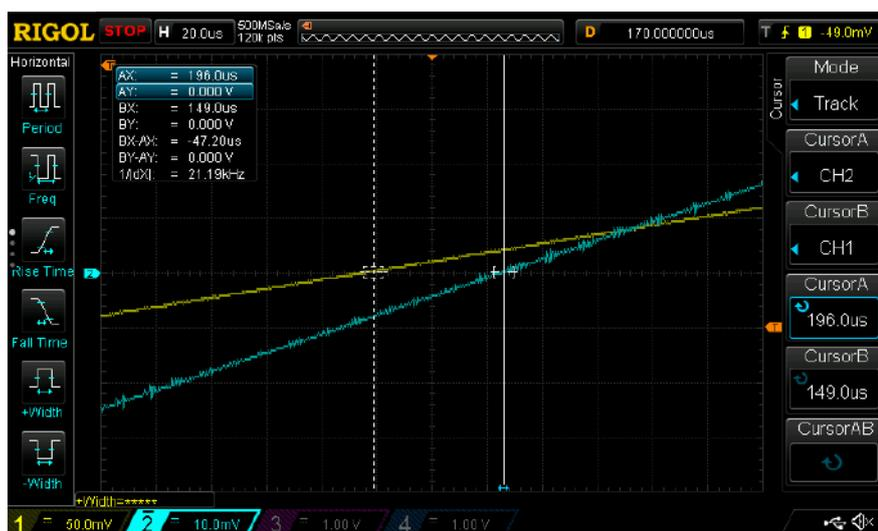
Figura 5.4: En violeta la onda de la sonda Ecamec y en celeste la onda de la sonda Kyoritsu. El  $\Delta t$  ( $BX - AX$ ) es de 47,2 [ $\mu s$ ] en adelante
