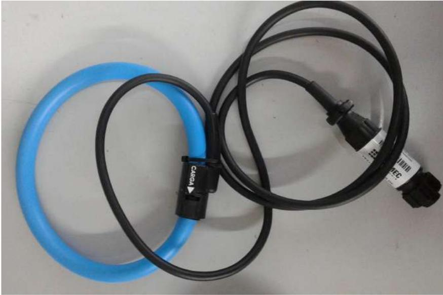
Figura 5.1: Sensor de corriente ECAMEC TI-Flex 400
