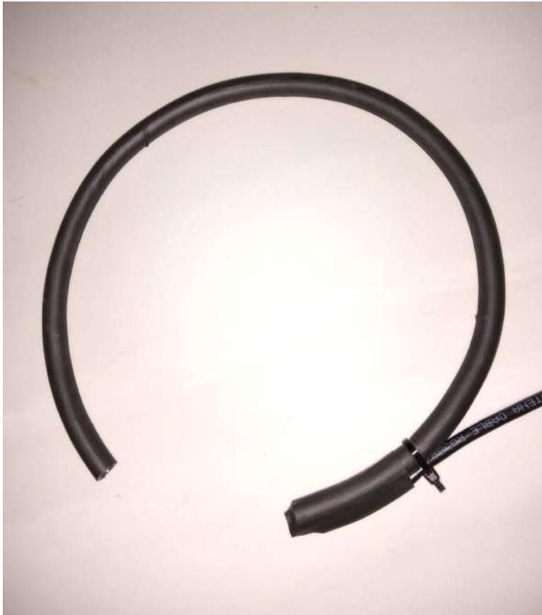
Figura 4.5: Cabezal del sensor con cubierta de material termocontraíble
