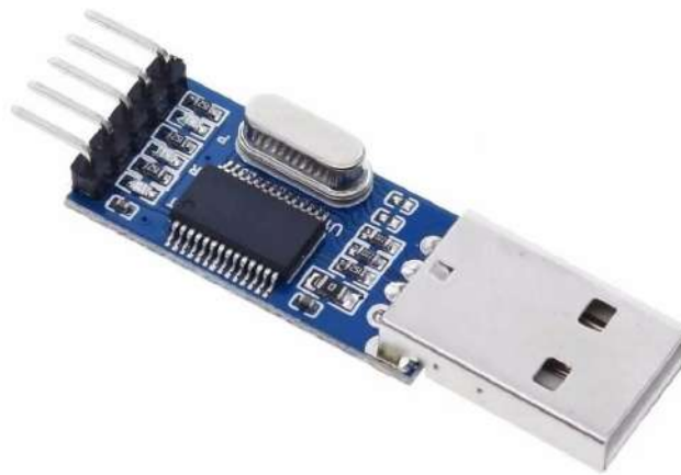
Figura 3.7 - Módulo UART-USB basado en PL2303HX
