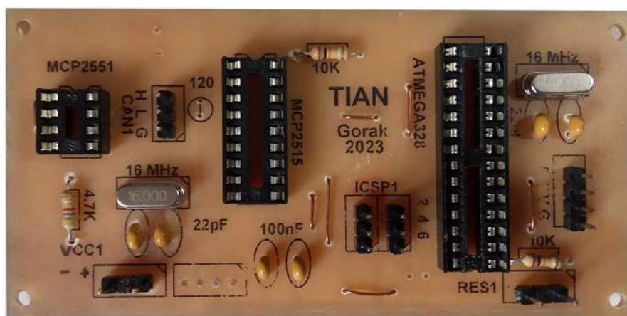
Figura 4.3 - Placa Adquisidor de Datos Componentes
