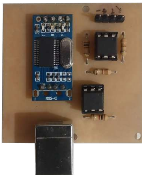
Figura 4.7 - Placa Módulo UART-USB Componentes
