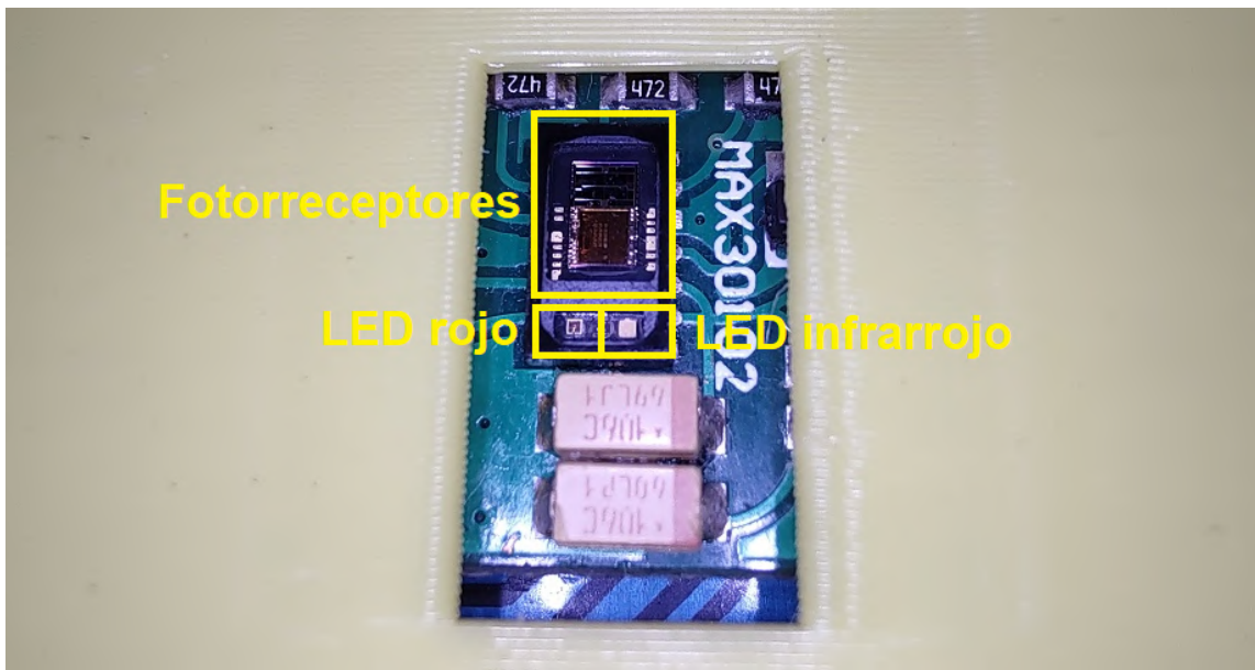
Figura 11: sensor de oximetría de pulso MAX30102.
