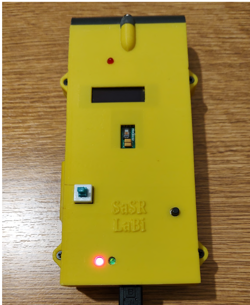
Figura 17: LED indicador de carga en curso.
