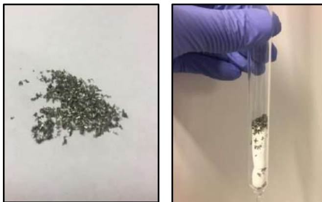
Figura 5.22. Sistema experimental utilizado para la reducción de las estructuras porosas de \text{TiO}_2 . Izquierda: virutas de Zr metálico. Derecha: piezas porosas sinterizadas junto con las virutas de Zr dentro de un tubo cerrado al vacío.
