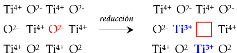
Figura 5.6. Representación del proceso de reducción de una red cristalina de TiO_2 . Por cada ion óxido que se pierde (indicado a la izquierda en color rojo) se genera una vacancia aniónica (representada a la derecha como \square ). Estas vacancias son formalmente compensadas por la adopción de un estado de oxidación más bajo en el metal (Ti (III), indicado en azul).
