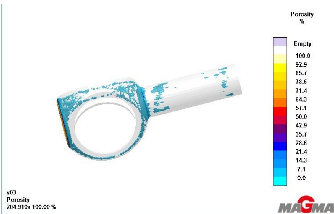
Figura 31. Ubicación y nivel de porosidad en Aleación de Aluminio AlSi7Mg para la situación sin sistema de colada.
