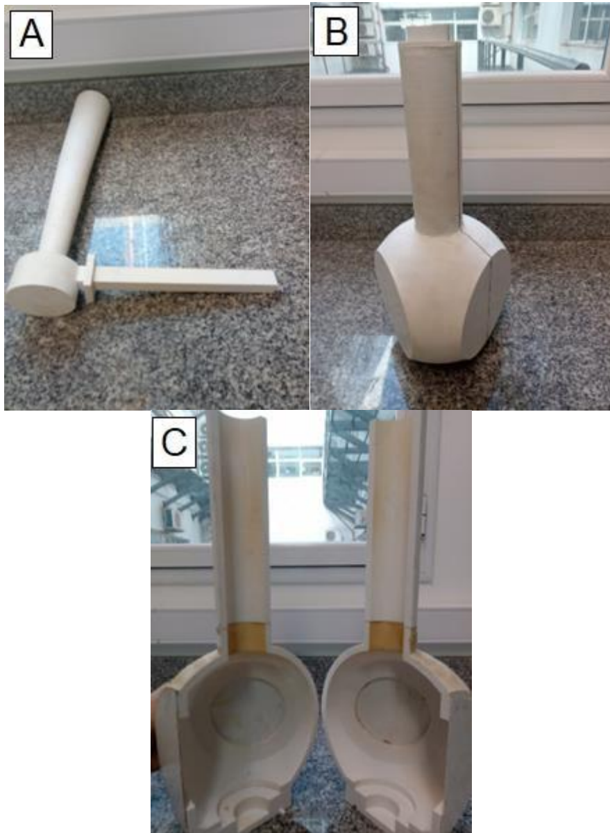
Figura 73. Modelos impresos en PLA de: A- Sistema de alimentación. B- Modelo. C- Caja de noyo.
