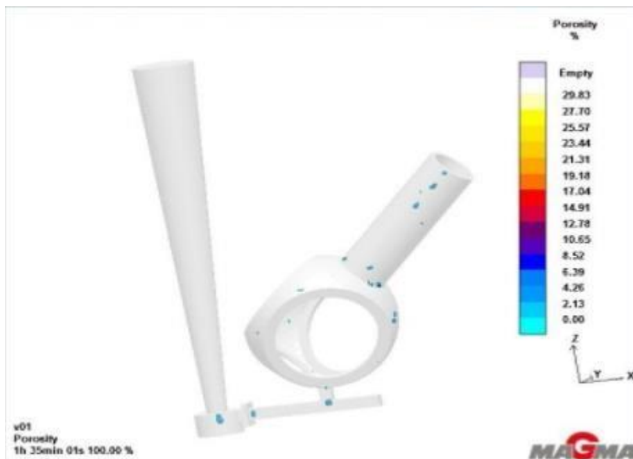
Figura 34. Porosidad en la pieza una vez solidificada. Material: Fundición Gris GJS 700, Temperatura de colada: 1450°C, Temperatura de molde: 25°C, Moldeo: vertical.
