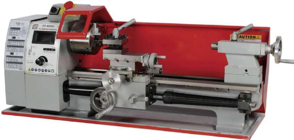
Figura 67. Ejemplo de torno que cuenta con protección para el tornillo de avance.
