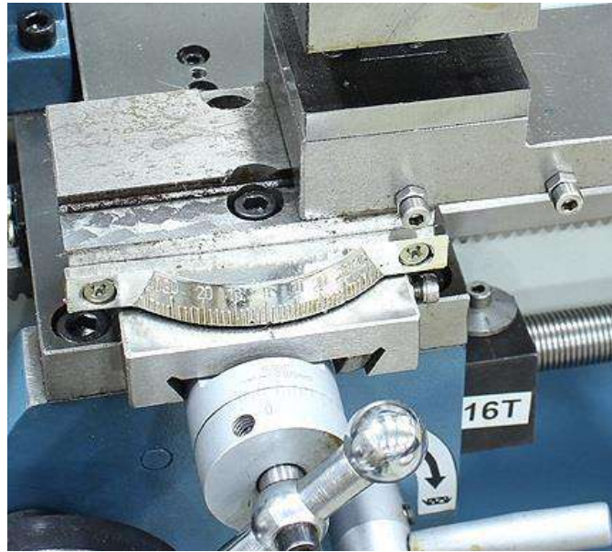
Figura 94. Ejemplo de transportador observable en un torno de banco económico. La pieza es frágil y de reducida utilidad, debido a su fabricación en plástico y al limitado rango de ángulos que figura en ella.
