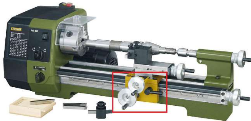
Figura 42. Torno de banco Proxxon PD 400, con su delantal marcado con rojo
