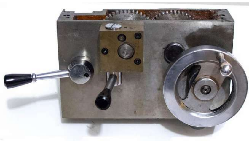
Figura 43. Delantal de torno retirado del carro
