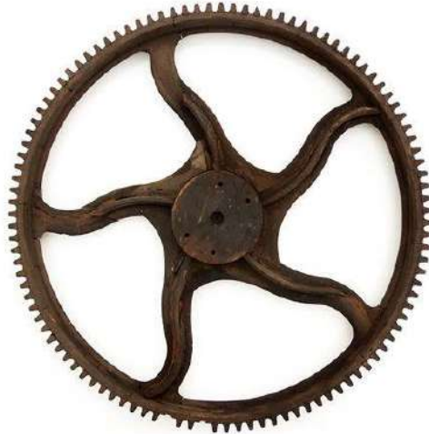
Figura 61. Ejemplo de engranaje no macizo, que presenta un anillo exterior en el que se encuentra el dentado, unido al cuerpo central por medio de brazos.
