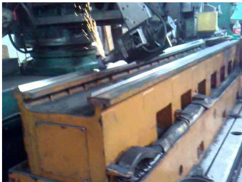
Figura 15. Bancada de torno siendo mecanizada en rectificadora.
