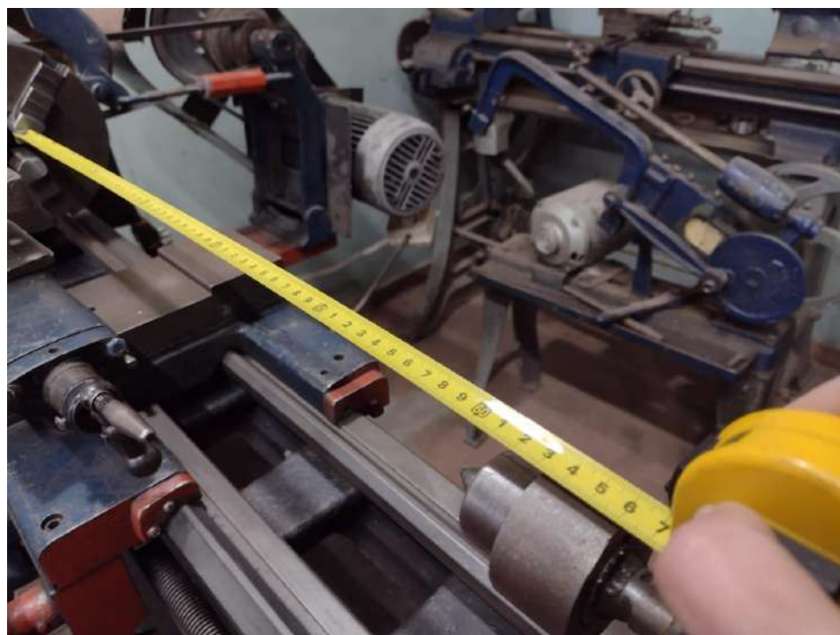
Figura 14. Medición de la distancia entre puntas, que resultó ser de aprox. 600 mm.
