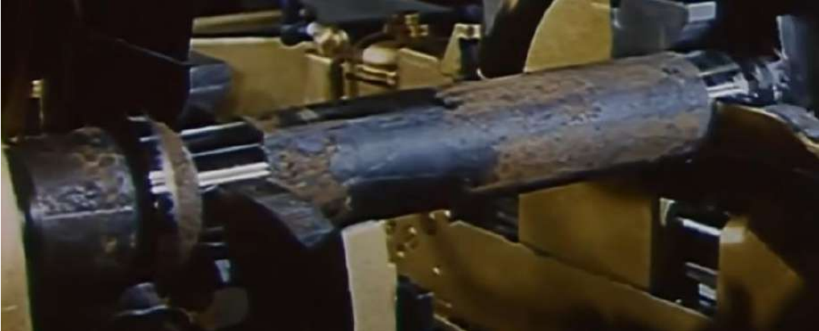
Figura 96. Husillo luego del forjado, antes de pasar por sucesivas etapas de mecanizado que lo llevarán a su geometría final.
