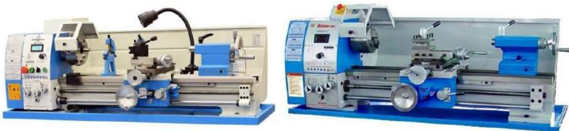
Figura 77. Burani WM280AV-F/700 (izq.) y Precision Matthews PM-1130V (der.). Nótese como el husillo de cilindrar tiene aproximadamente el mismo diámetro que el tornillo de avance.
