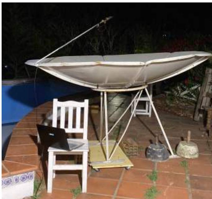
Figura 3.110: Configuración *hardware* 1,7 GHz con reflector de 2,4 mts.
