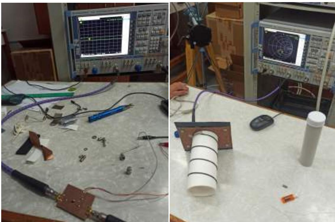
(a) Mediciones del LNA de 1,7 GHz con VNA (b) Mediciones de antena helix con VNA
