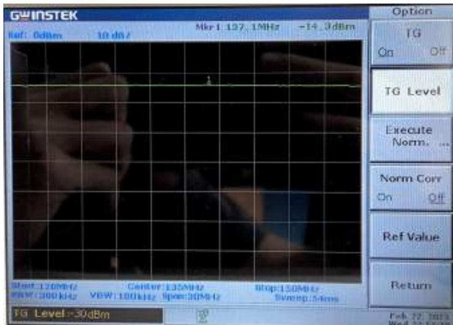
Figura 3.66: Medición de ganancia del LNA de 137,1 MHz.
