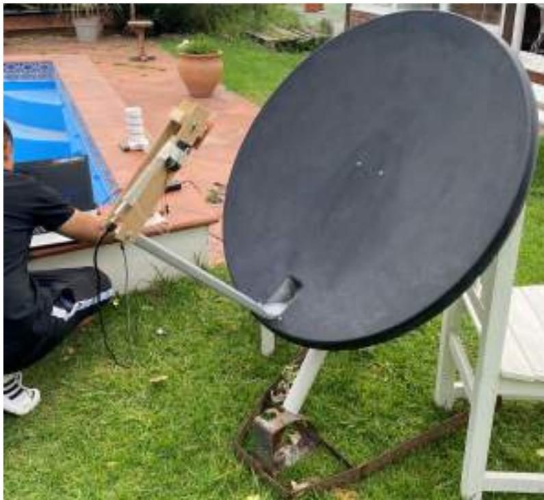
Figura 3.46: Reflector de televisión satelital con antena *Patch*.
