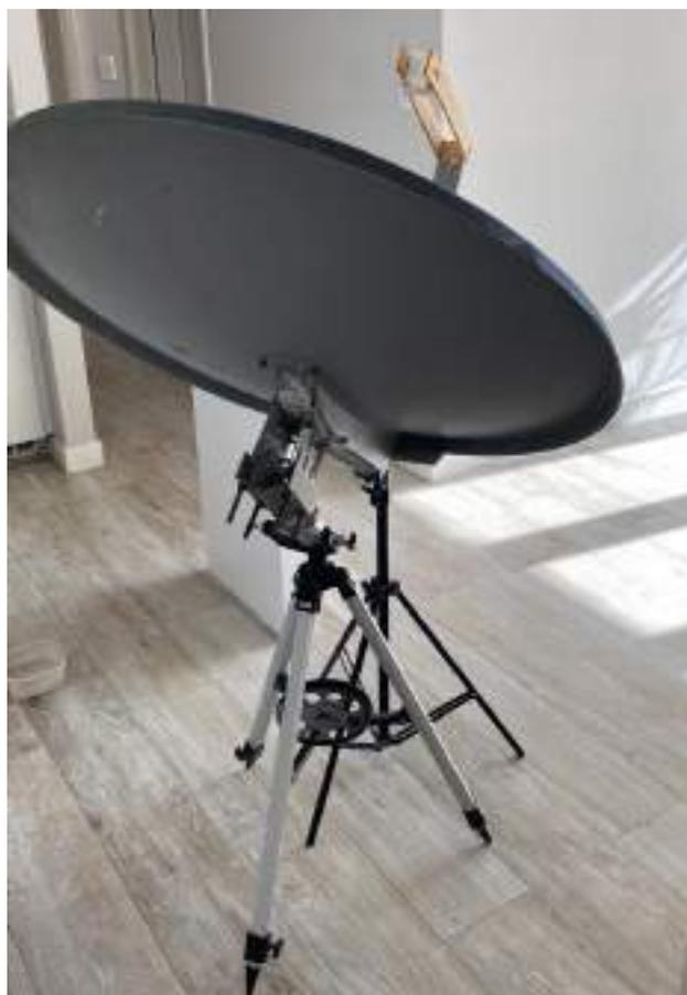
Figura 3.112: Reflector parabólico montado sobre trípode de telescopio.
