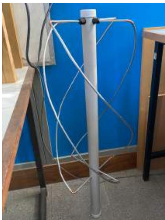
Figura 3.13: Ensamble antena *QHF*.
