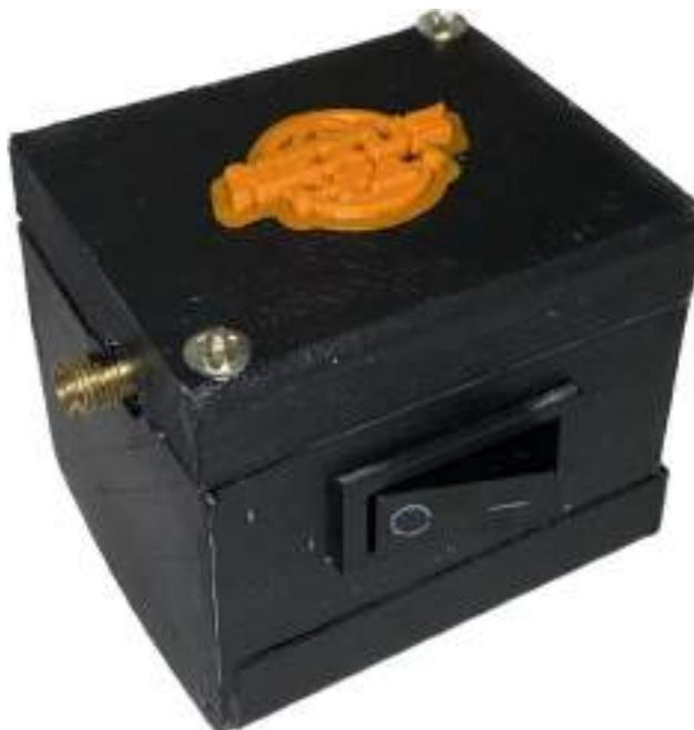
Figura 3.106: Caja LNA 1,7 GHz - impresión 3D.
