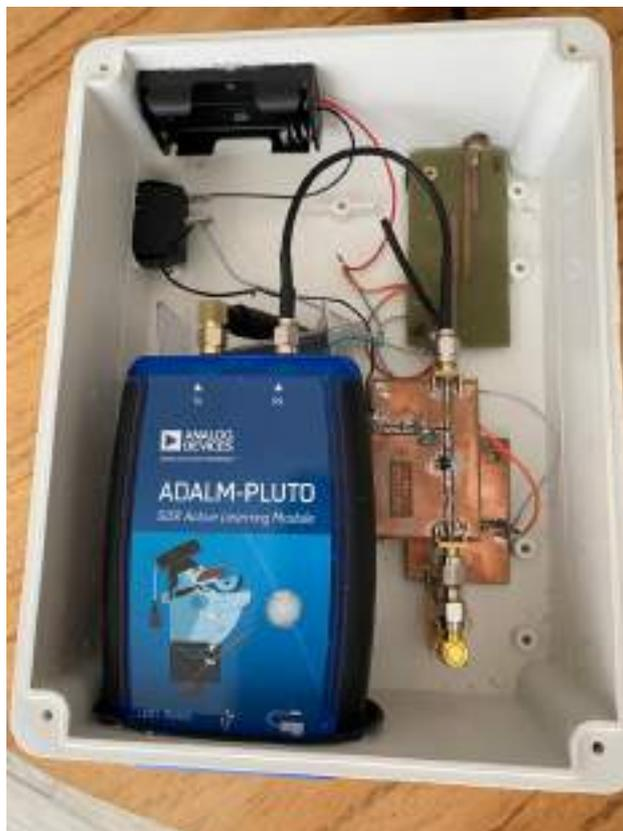
Figura 3.105: Circuitería RF 1,7 GHz.
