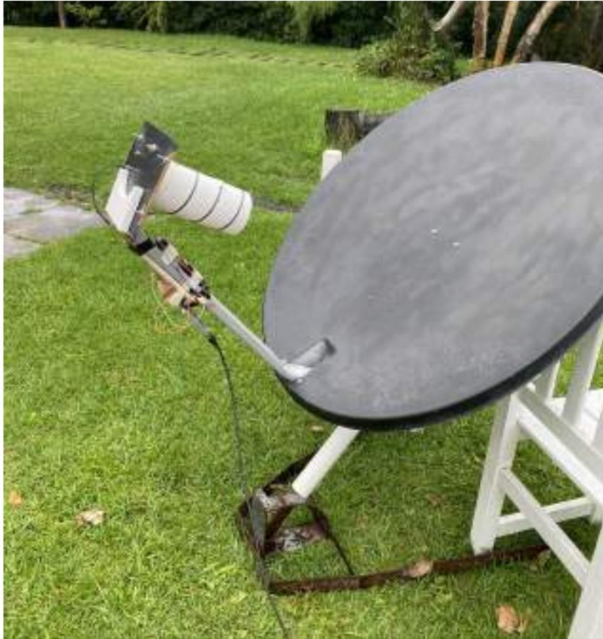
Figura 3.39: Reflector de televisión satelital con antena *Helix*.
