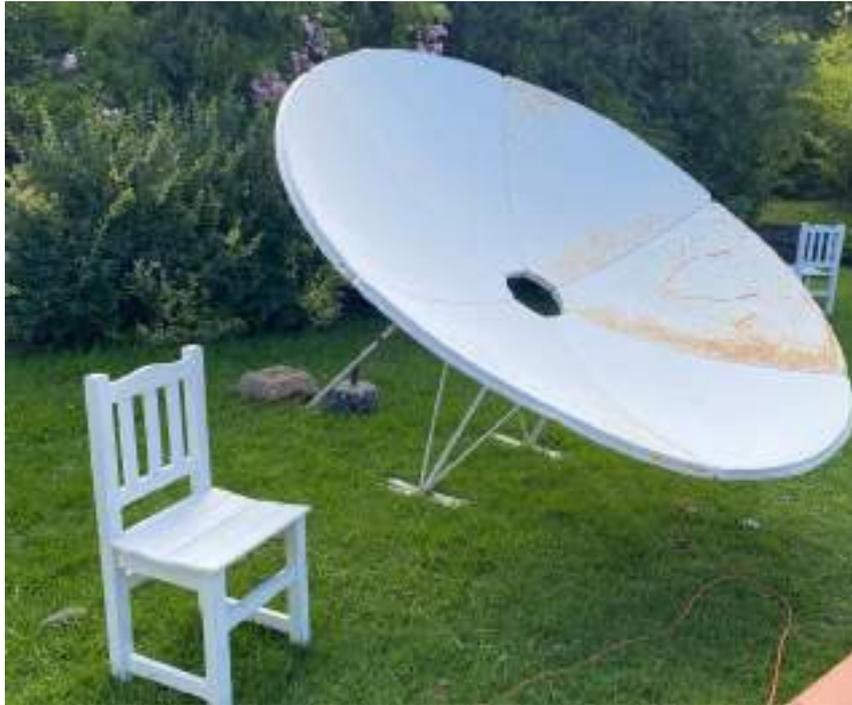
Figura 3.48: Reflector con foco centrado 2,4 mts de diámetro.
