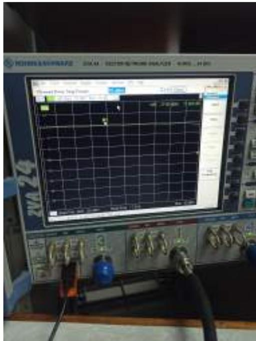
Figura 3.72: Barrido de potencia de LNA de 1,7 GHz con VNA.
