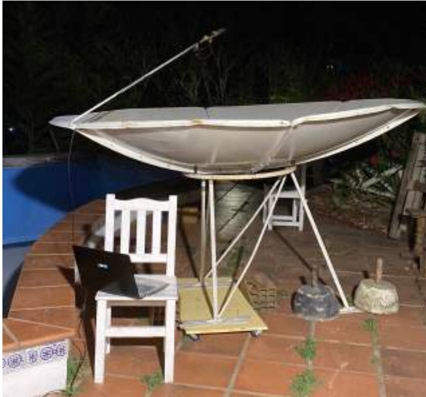
Figura 3.50: Reflector con iluminador *Patch*.
