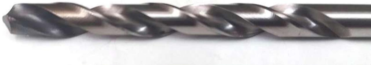
**Figura 138.** Broca afectada térmicamente
