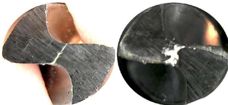
**Figura 122.** Imágenes frontales de la herramienta afilada con un ángulo de incidencia principal ( $\gamma_1$ ) de  $15^\circ$  y un ángulo de incidencia secundario ( $\gamma_2$ ) de  $25^\circ$  para el ensayo E5: **Izq)** previo a ser ensayada y **Der)** al final de su vida útil.
