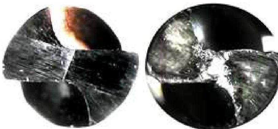
**Figura 120.** Imágenes frontales de la herramienta afilada con un ángulo de incidencia principal ( $\gamma_1$ ) de  $15^\circ$  y un ángulo de incidencia secundario ( $\gamma_2$ ) de  $25^\circ$  para el ensayo E4: **Izq)** previo a ser ensayada y **Der)** al final de su vida útil.
