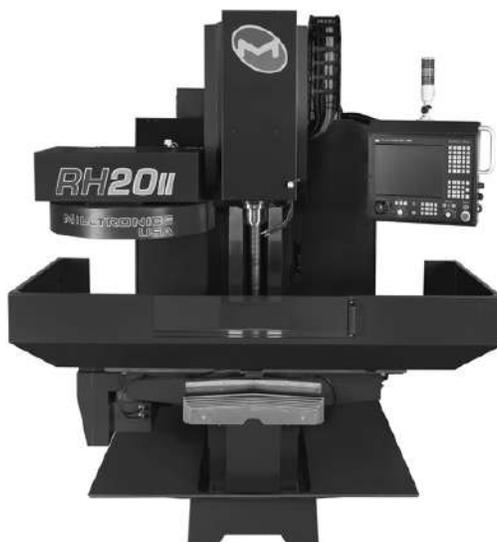
**Figura 46.** Fresadora de control numérico Milltronics RH20.
