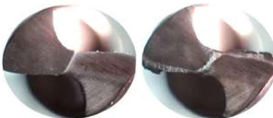
**Figura 116.** Imágenes frontales de la herramienta afilada con un ángulo de incidencia principal ( $\gamma_1$ ) de  $15^\circ$  y un ángulo de incidencia secundario ( $\gamma_2$ ) de  $30^\circ$  para el ensayo E2: **lzaq**) previo a ser ensayada y **Der**) al final de su vida útil.
