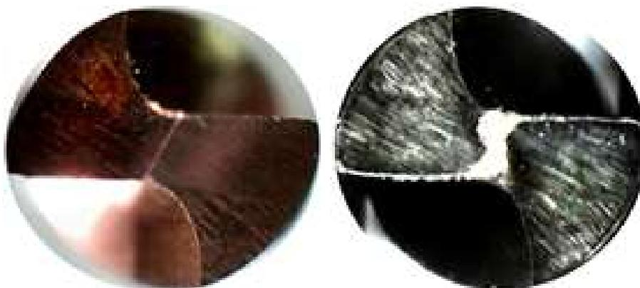
**Figura 118.** Imágenes frontales de la herramienta afilada con un ángulo de incidencia principal ( $\gamma_1$ ) de  $15^\circ$  y un ángulo de incidencia secundario ( $\gamma_2$ ) de  $25^\circ$  para el ensayo E3: **Izq)** previo a ser ensayada y **Der)** al final de su vida útil.
