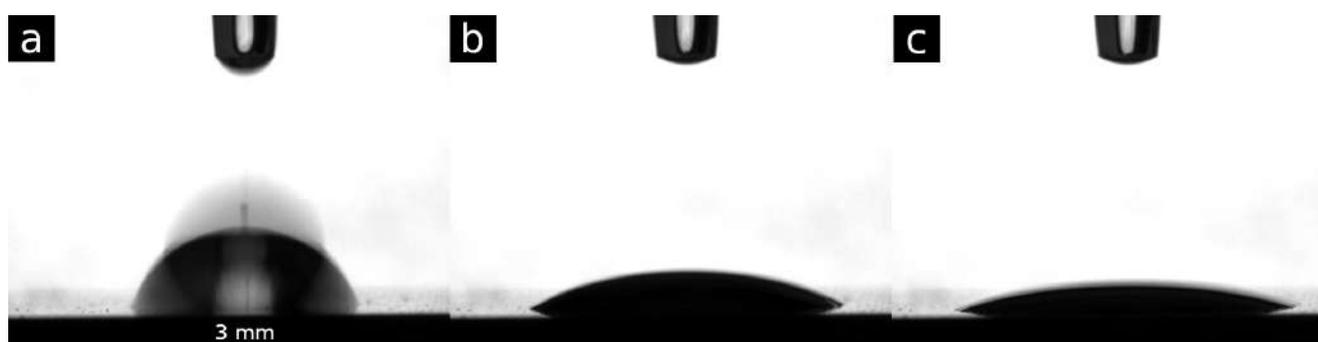
**Figura 105.** Progresión del mojado del lubricante B sobre una muestra ADI rectificada a los **a)** 0 s, **b)** 0,3 s y **c)** 1,9 s
