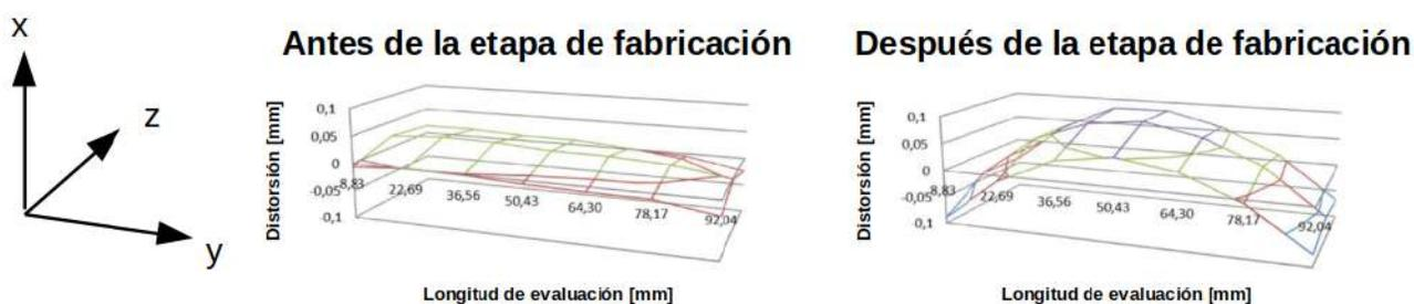
**Figura 48.** Gráficos tridimensionales de la superficie palpada antes y después de la etapa de fabricación (capturas del software CosmosM).
