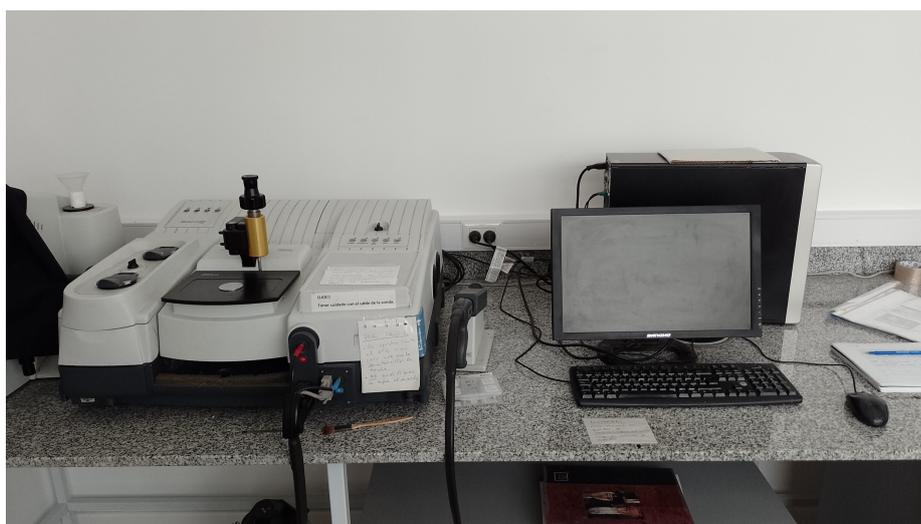
**Figura 20.** Equipo de Espectroscopia infrarroja por transformada de Fourier (FTIR).
