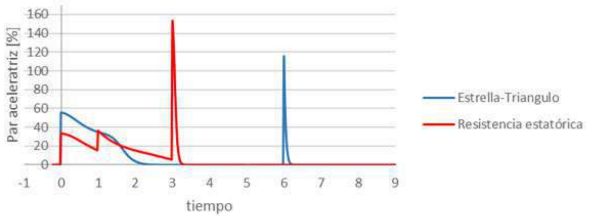
Figura 6.80 - Comparación del par aceleratriz del conjunto, en función del tiempo, en ambos arranques. (Fuente: elaboración propia)
