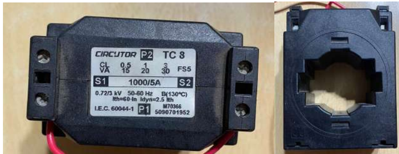
Figura 6.5 – Transformador de intensidad CIRCUITOR TC8. (Fuente: Elaboración propia)
