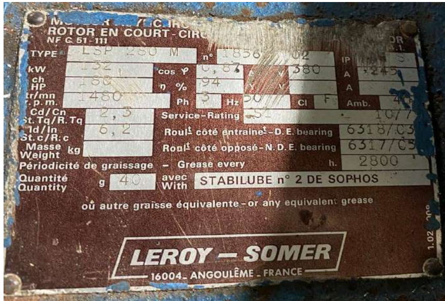
Figura 6.1 - Chapa característica compresor 3. (Fuente: Elaboración propia)
