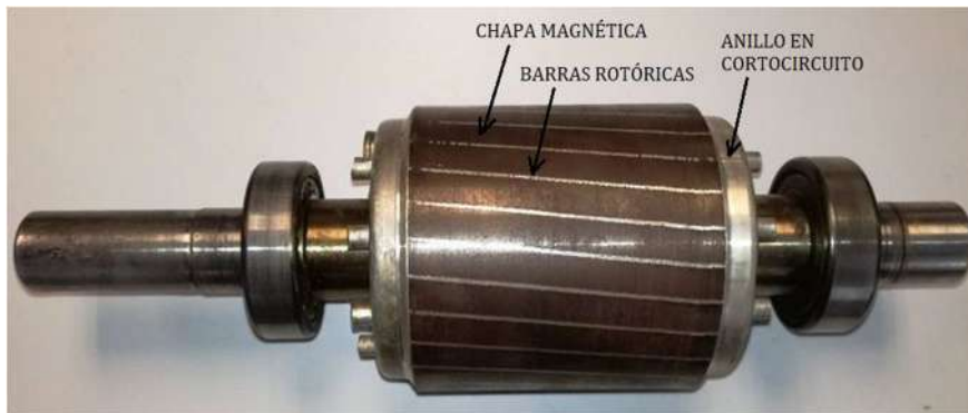
Figura 2.13 – “Rotor tipo jaula de ardilla” (Fuente: [Herrera Guachamin ( 2018). Análisis de la eficiencia de los motores de inducción que operan bajo diferentes condiciones de fallos])
