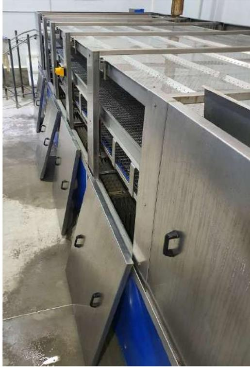
Figura 2. Enfriadora de langostinos, en la parte inferior se observa la batea con recubrimiento azul.
