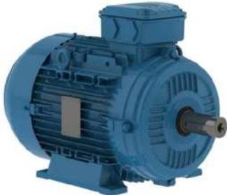
El motor W21 Multimontaje posee carcasa de aluminio y patas removibles. Este motor es capaz de suministrar gran flexibilidad y facilidad en el cambio de configuración, sin necesidad de mecanizado o modificaciones adicionales. Su caja de conexión puede ser rotada de 90 en 90 grados, permitiendo la conexión de los cables del motor en cualquier lado. Además de eso, estos motores son totalmente intercambiables con los motores de hierro fundido.
