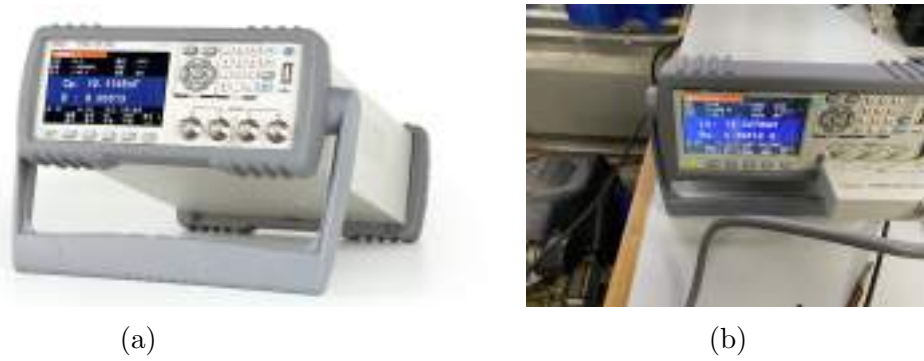
Figura 5.17: Medidor LCR utilizado: (a) vista en perspectiva; (b) su configuración.
