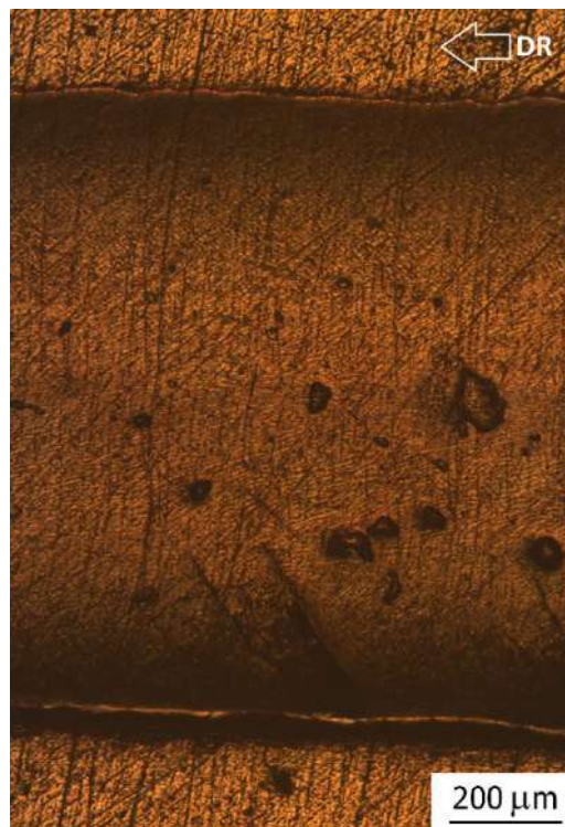
Figura 62. Imagen del camino de rodadura de una probeta del G2, donde se distingue material desplazado hacia los bordes. Aumento x5.
