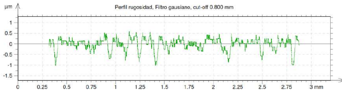
Figura 39. Perfil de rugosidad característico de una probeta del G0.
