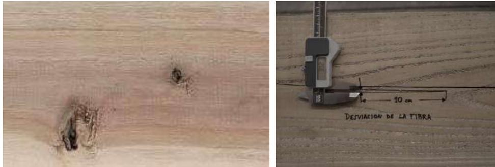
**Figura 1.11.** Defectos de la madera: nudos (izquierda) y desviación de fibras (derecha).
