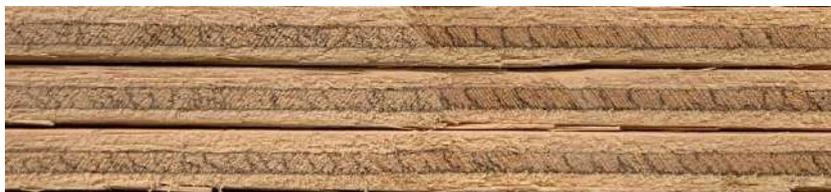
**Figura 1.14.** *Lathe checks* visibles en placa central del contrachapado.
