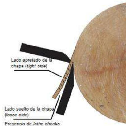
**Figura 1.13.** Formación de *lathe checks* durante corte giratorio.
