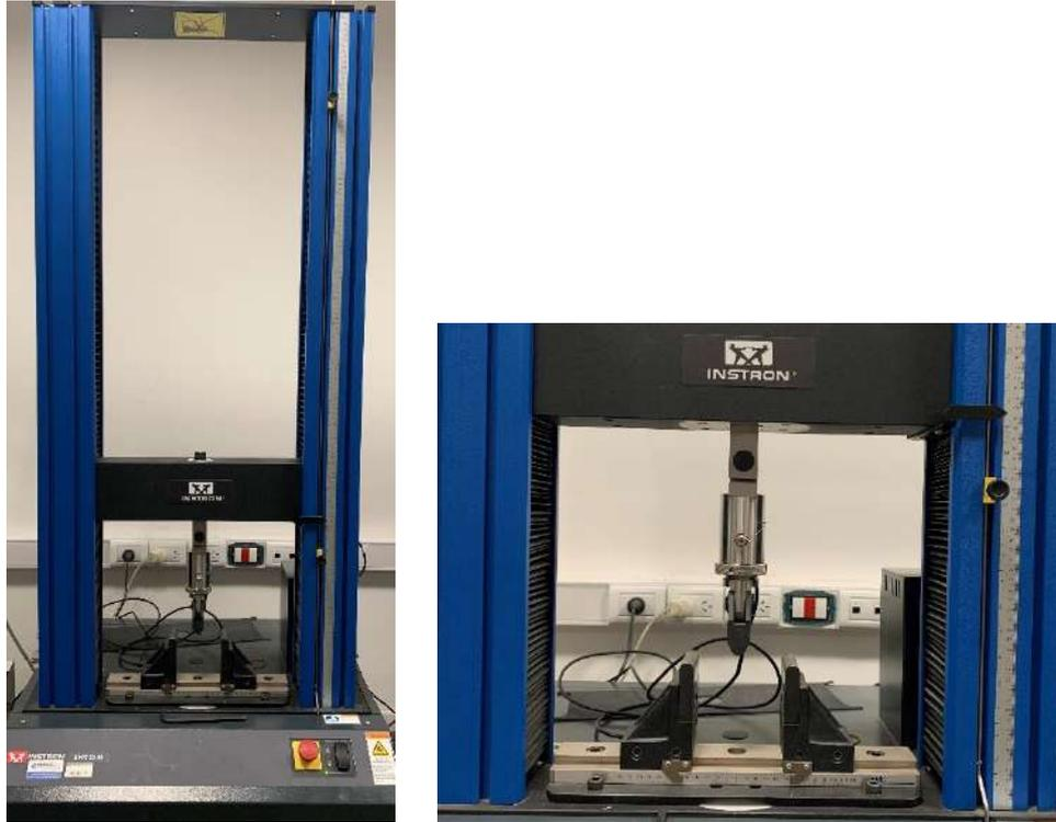
**Figura 2.6. (a)** Máquina de ensayo universal y **(b)** configuración correspondiente a un ensayo de flexión en 3 puntos.
