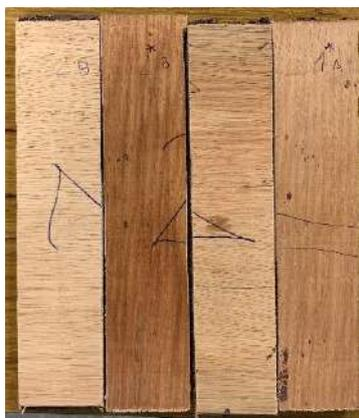
**Figura 2.5.** Probetas a ensayar: D2 transversal y longitudinal; D1 transversal y longitudinal (de izquierda a derecha).
