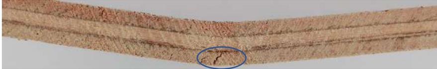
**Figura 3.15.** Probeta ensayada con disposición transversal (DT).
