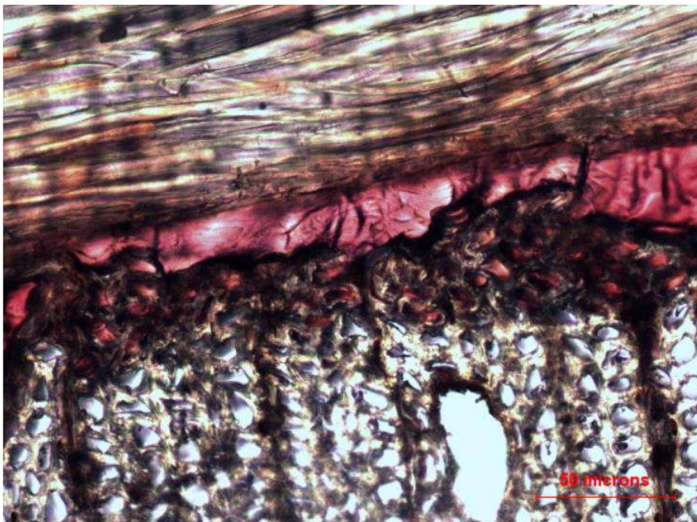
**Figura 3.5.** Imagen de la línea de encolado obtenida con microscopía óptica. Aumento de 20X
