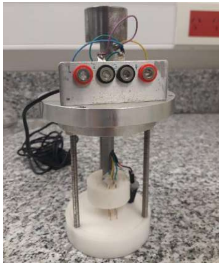
Figura 4.8 Celda de cuatro puntas utilizada para la medición de las propiedades eléctricas.
