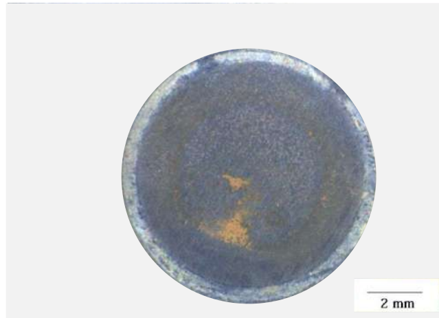
Figura 53. Superficie del ADI luego del ensayo de polarización.
