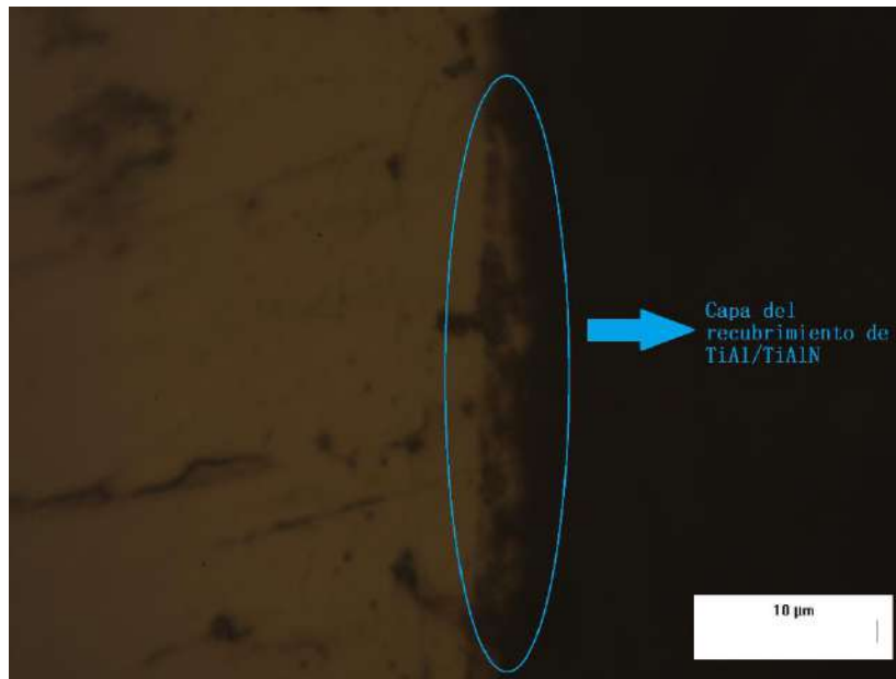
Figura 62. Sección transversal (experimental). Identificación del recubrimiento (x100 aumentos).
