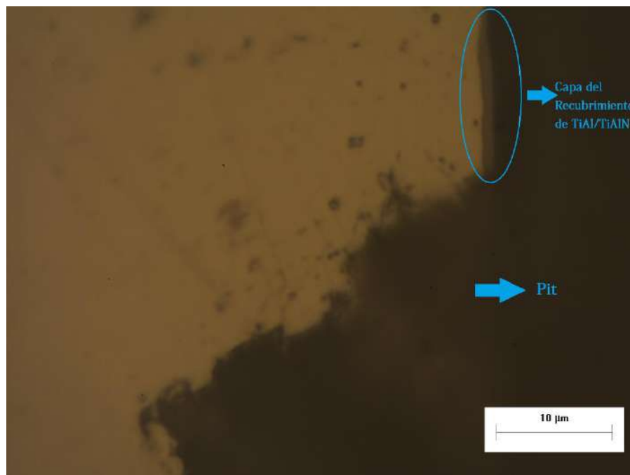
Figura 60. Sección transversal de probeta Industrial. Identificación del recubrimiento y pit (x100 aumentos).
