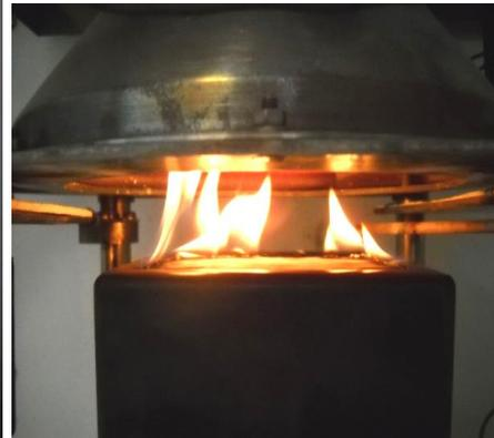
Figura VIII.1. Fotografías del calorímetro de cono utilizado y del ensayo de una de las muestras.
