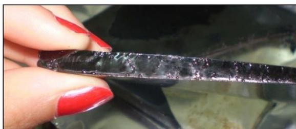
Figura IV.2. Sección transversal de un placa de resina furánica curada mediante el ciclo (1)
