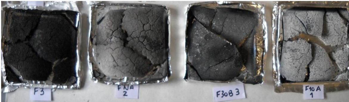
Figura VIII.8. Aspecto final de las placas luego del ensayo en el calorímetro de cono.
