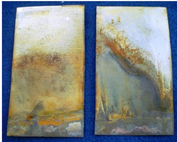
Figura VII.4. Fotografías de las placas de hojalata sin recubrir luego de 30 días de inmersión en una solución de NaCl 0,15 mol/L
