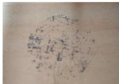
Figura VII.8. Fotografía de una placa de hojalata recubierta, luego del ensayo potenciométrico (destrutivo), donde se observa la corrosión puntual.
