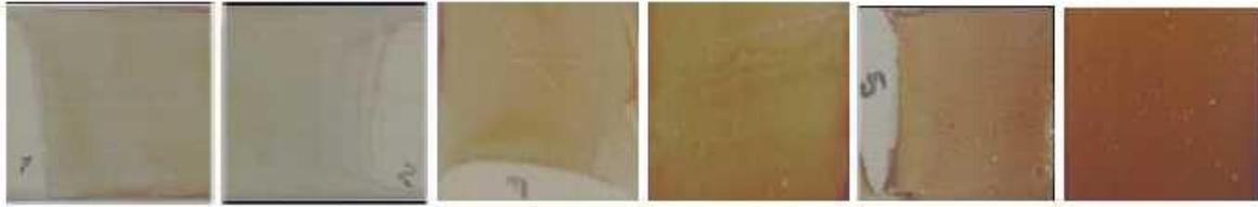
Figura IV.4. Recubrimientos obtenidos por *dipping* a partir de soluciones de concentración creciente de prepolímero en acetona: 2,5%, 5%, 7,5%, 10%, 15% y 20% p/p.
