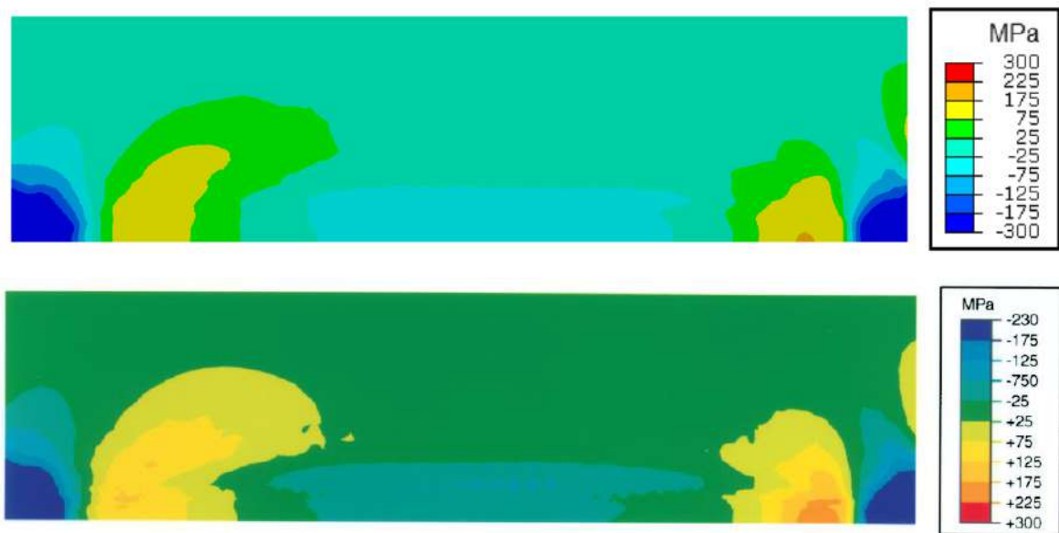
FIGURA 4.2-17 TENSIONES RESIDUALES TRANSVERSALES. ARRIBA RESULTADOS DEL MODELO DESARROLLADO; ABAJO RESULTADOS NUMÉRICOS OBTENIDOS EN (DYE, HUNZIKER, & REED, 2001)
