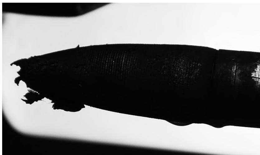
Figura F.4: Fotografía digital de silueta de mandril luego de una perforación mostrando escamas de óxido adheridas a su superficie. Además, se pueden apreciar gotas de agua incidiendo en la apreciación del perfil.
