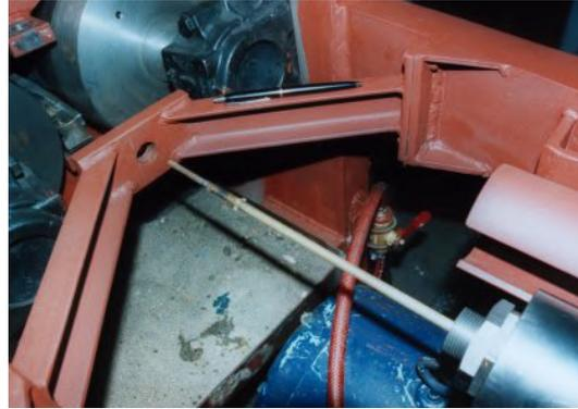
Figura A.3: Vista del tubo interno de refrigeración de la lanza porta mandriles (ha sido retirada para la foto)
