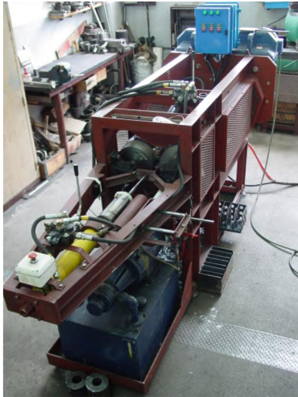
Figura 3.1: Primer prototipo de Perforador Mannesmann a escala de laboratorio, en funcionamiento en la Div.Soldadura y Fractomecánica - Intema
