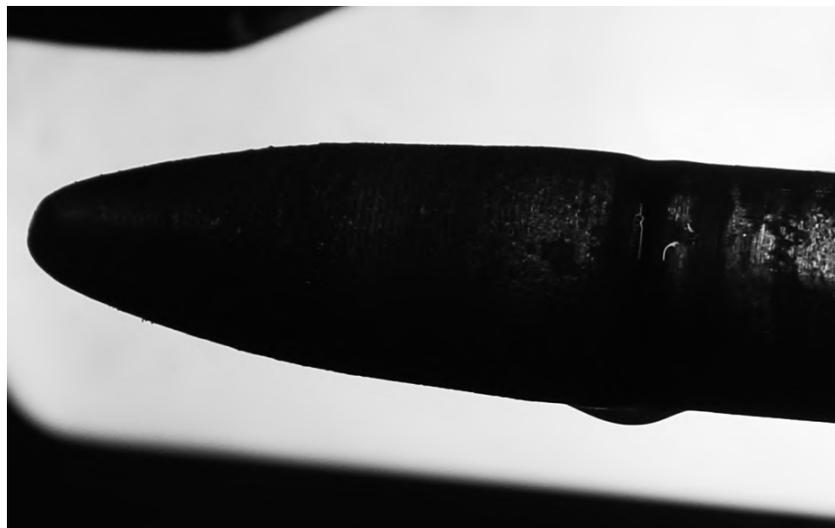
Figura F.3: Fotografía digital de silueta de mandril luego de una perforación mostrando una pérdida de agua de refrigeración a través de la junta roscada por daño del aislante.
