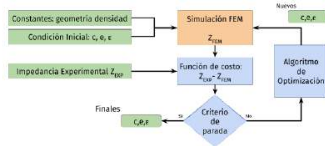
Figura 3.5. Diagrama de proceso de optimización utilizado en técnicas basadas en el MEF.
