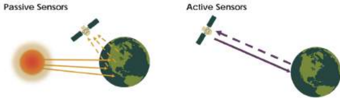
Fig. 2.3: Sensores pasivos y activos
