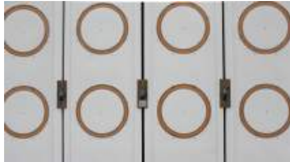
Fig. 2.9: Elementos radiantes del SAOCOM
