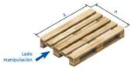
Figura 27: Manipulación de pallet estantería selectiva.
