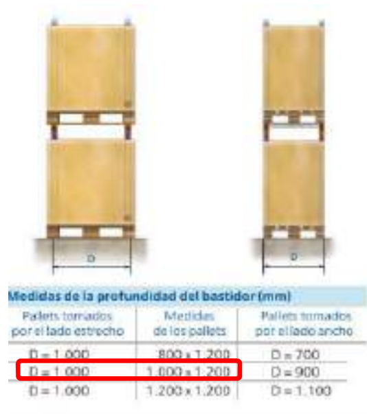
Figura 30: Profundidad de bastidor.
