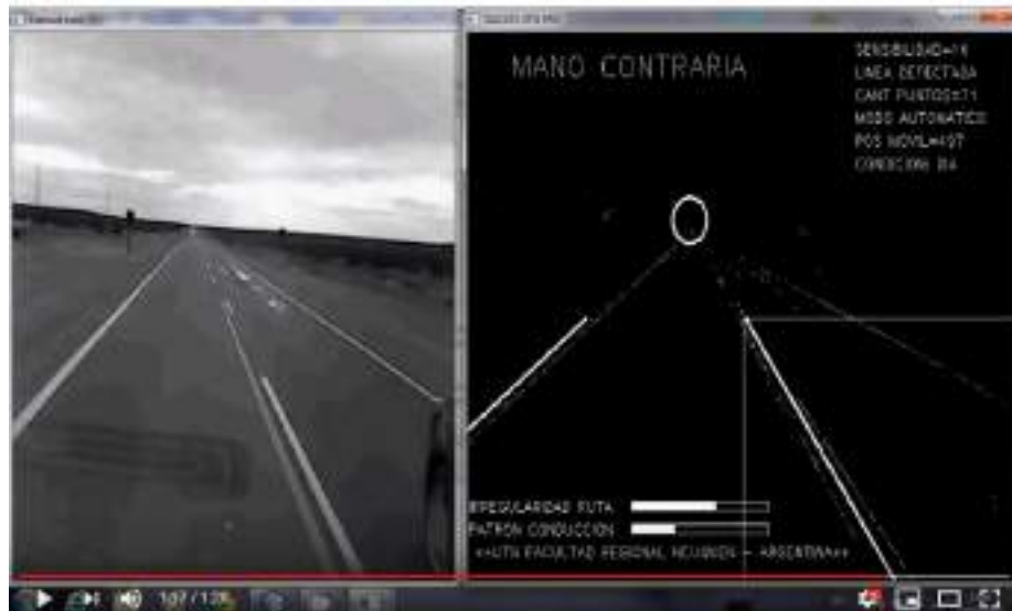
Figura 4.12 Interfase visual implementada para los ensayos. En este caso se ubica al móvil en la mano contraria.
