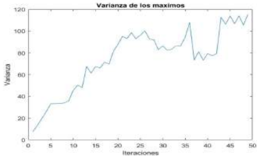
Figura 2.23. Evolución de la varianza de la posición de los máximos para el caso de una señal aperiódica.
