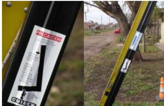
*Fotografía XI. Marca en escalera extensible para correcta inclinación- Fuente Propia*
