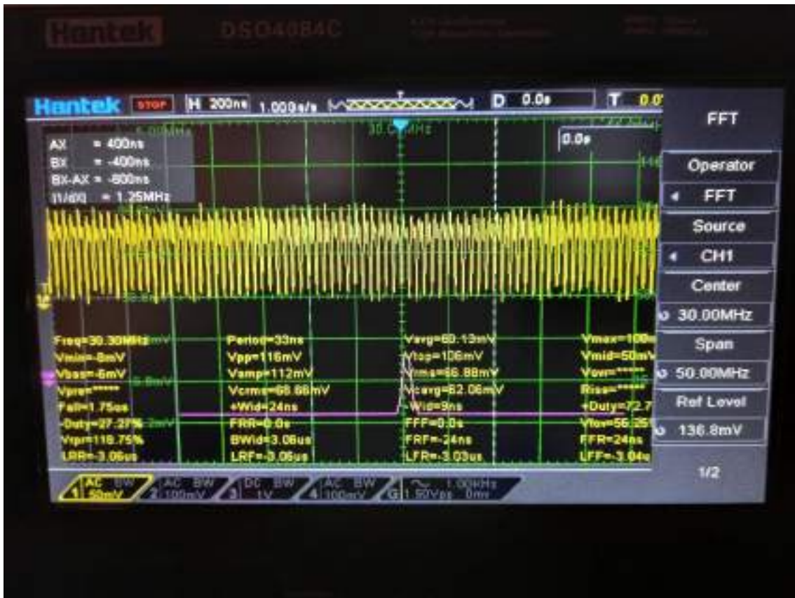
Figura 3.41: Señal de RF a la entrada del filtro MAX7400
