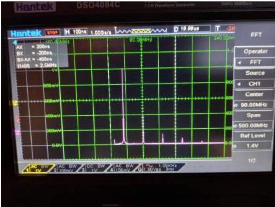
Figura 3.19: Contenido espectral de la señal de 30 MHz a la entrada del filtro de RF
