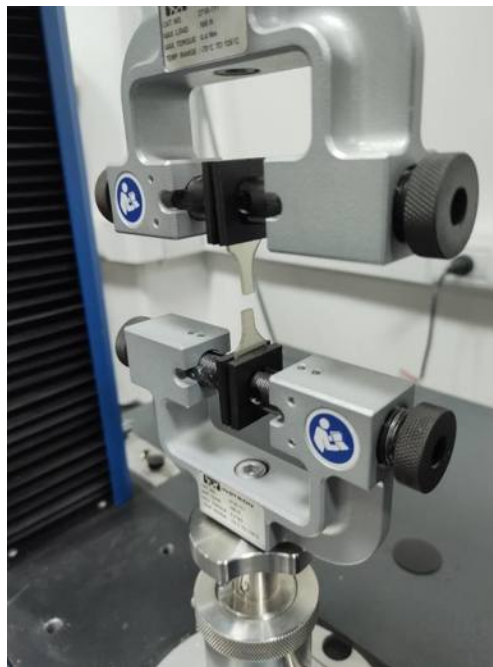
Figura 8. Probeta de TPS4 una vez finalizado el ensayo de tracción.
