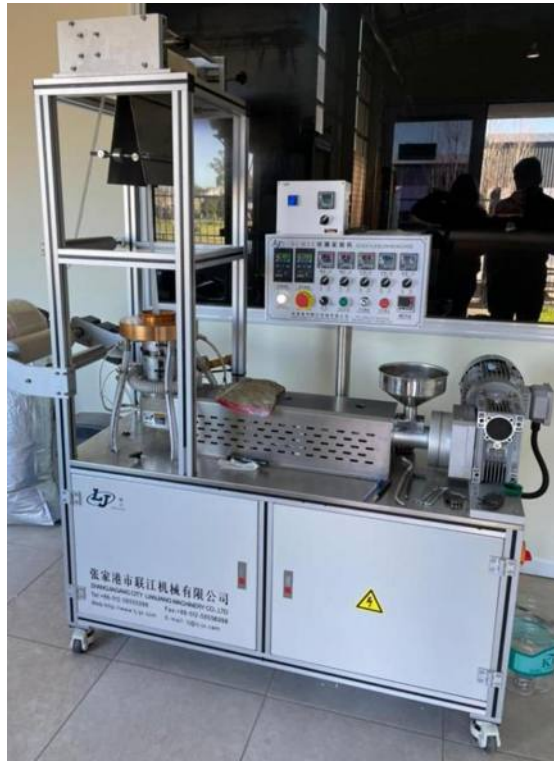
Figura 7. Línea de extrusión monotornillo-soplado de películas.
