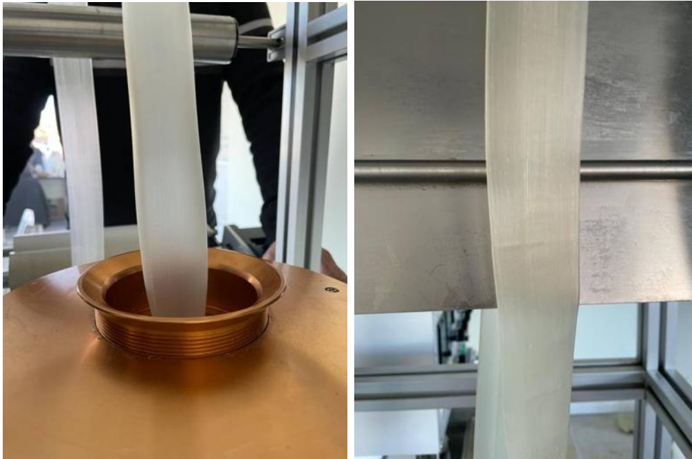
Figura 28. Procesamiento de películas de TPS2 en línea de extrusión monotornillo-soplado.
