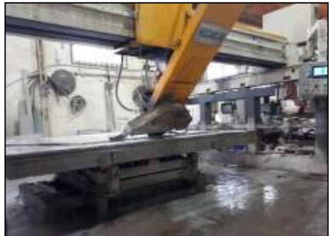
Figura 10- Mesa cortadora eléctrica, realizando corte a 45°. Fuente propia.
