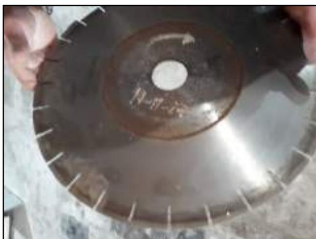
**Figura 53- Disco de corte diamantado con alma silenciosa. Fuente propia.**
