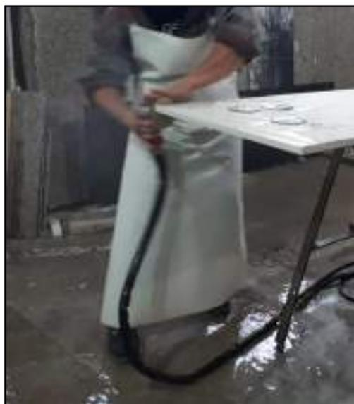
Figura 55- Lijadora inyectando agua a presión. Fuente propia.
