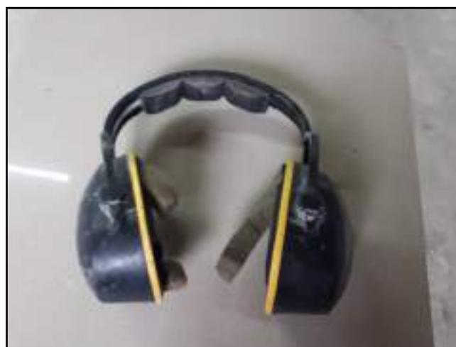
**Figura 52- Protección auditiva en mal estado. Fuente propia.**
