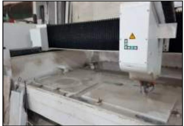
Figura 17- Cortadora realizando cortes ovalados. Fuente propia.
