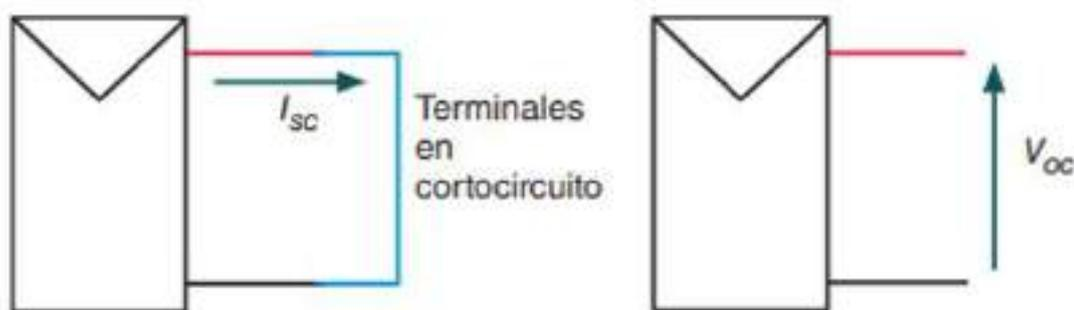
Figura 2.7.2.1 – Características técnicas de una placa solar: corriente de cortocircuito ( $I_{SC}$ ) y tensión a circuito abierto ( $V_{OC}$ ). Fuente: catálogo del fabricante SOLARTEC®.
