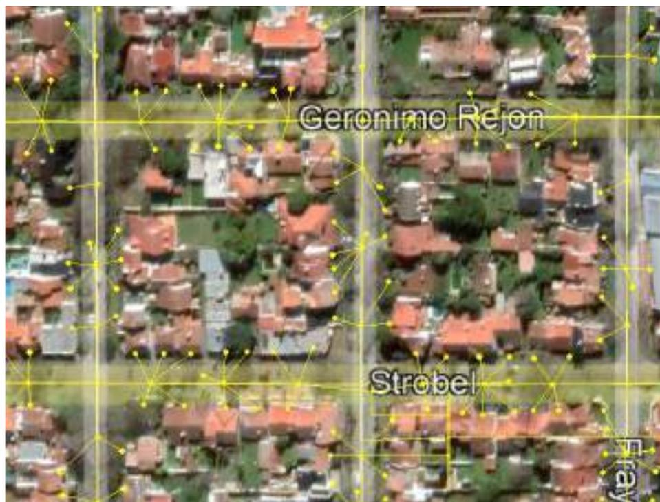
Figura 2.5.5.4 – Red de distribución secundaria de la subestación SE\_73S00353, en el entorno de DIgSILENT.
